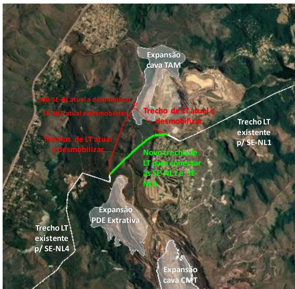
Figura 5.4-14: Novo trecho de linha em 138 kV para conectar as atuais linhas provenientes das subestações da CEMIG SE-NL1 e SE-NL4.
