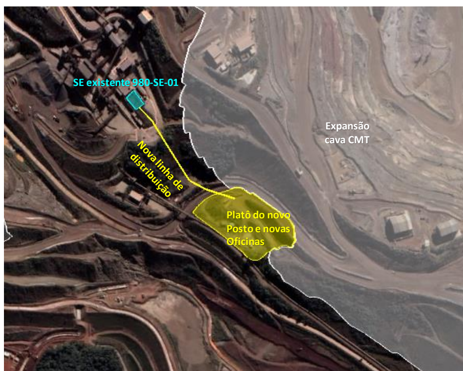
Figura 5.4-34: Traçado da Rede de Distribuição Protegida da atual subestação principal de CMT (980-SE-01) até o eletrocentro no novo platô do Posto de Combustível e Oficinas.
