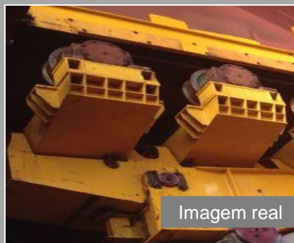
Balancim aplicado em sistema de translação
