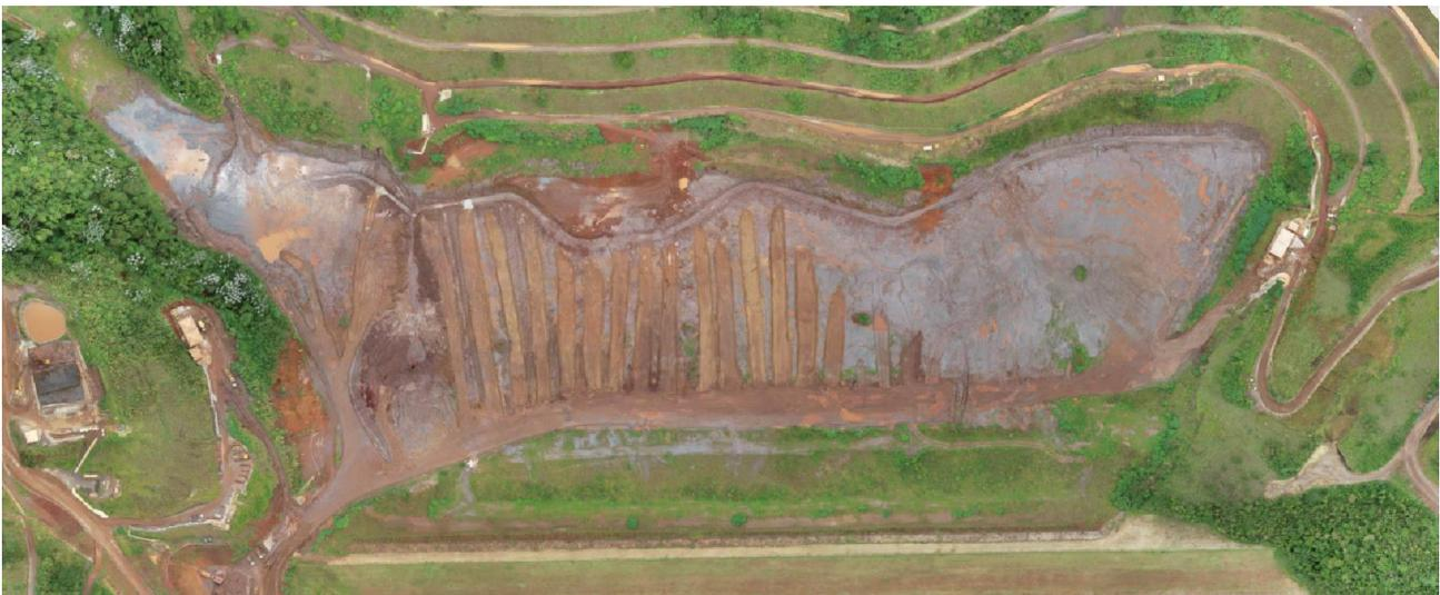
**Figura 9:** Visão geral – canal no reservatório de drenagens – sump – desvio e disciplina de águas – jan/2024.
