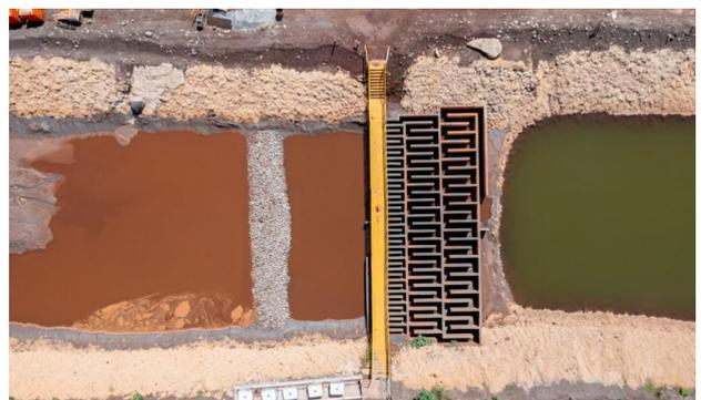
**Foto 18:** Destaque para as chincanas instaladas no sump da PDR. Fonte: Vale, 2024
