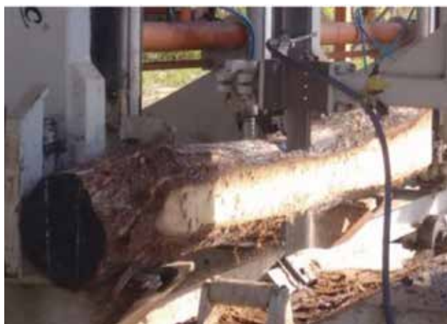
Figura 2. Operação de desdobro primário das toras em serra de fita vertical, com volantes de 1,20m de diâmetro e alimentação/avanço feita por carrinho alimentador semi-automatizado.
