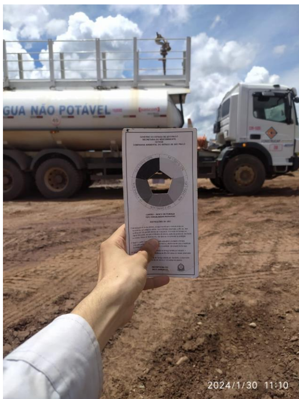
Foto 36. Controle de emissões atmosféricas proveniente da combustão de motores de equipamentos e veículos movidos a diesel.
