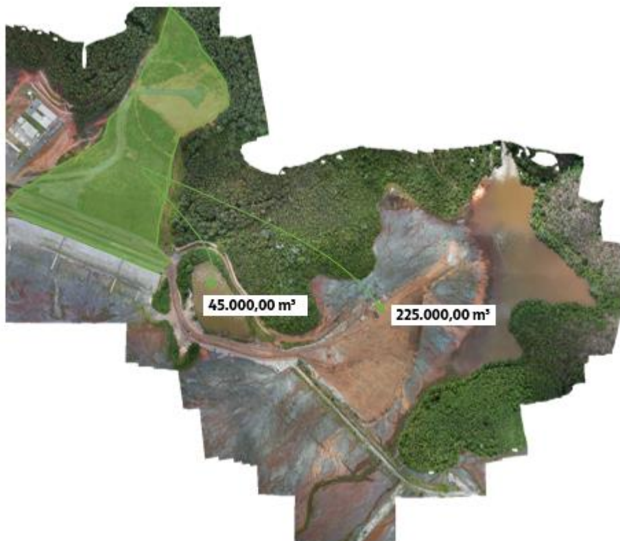
Figura 3. Localização da área de origem de material a ser escavado no Dique 1B (em verde) a ser destinado a ADME.
