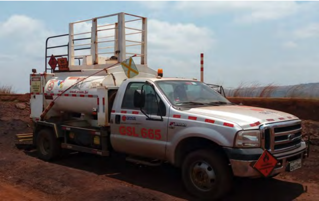
Tipo de caminhão comboio utilizado para abastecimento de instalações fixas
