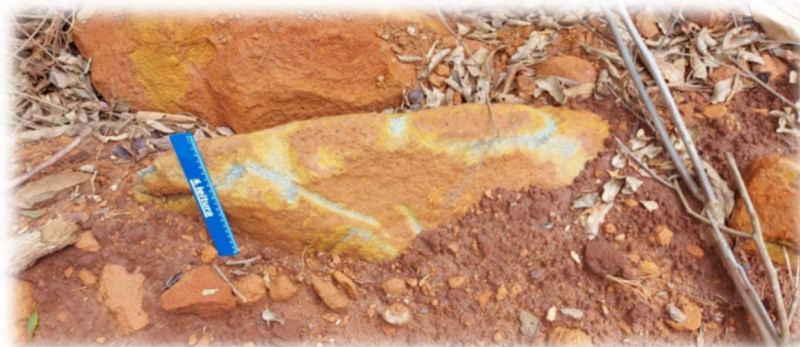
Figura 5.25 - Blocos de Gabro sob a ação do intemperismo, mostrando o material alterado em superfície, de cor amarela, da mesma tonalidade e textura dos saprolitos amarelos observado no leito da estrada
