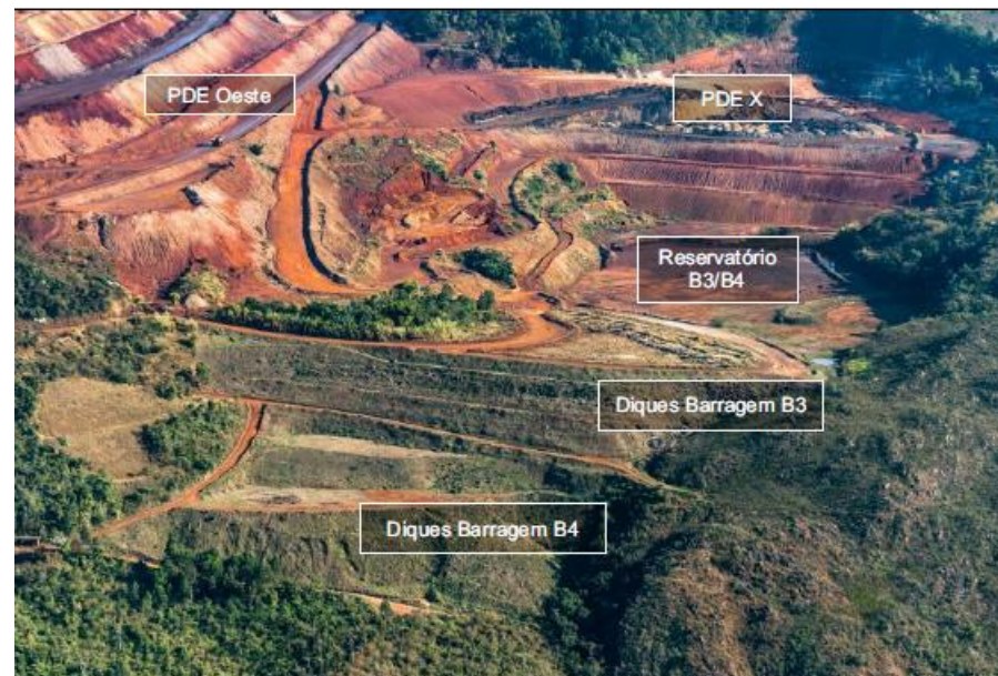
Principais estruturas da barragem B3/B4. Fonte: Geoestável, 2019
