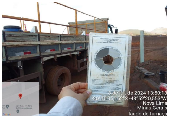
Foto 18: Monitoramento de fumaça preta dos veículos e equipamentos das frentes de serviço. (Fonte: Vale, julho de 2024)
