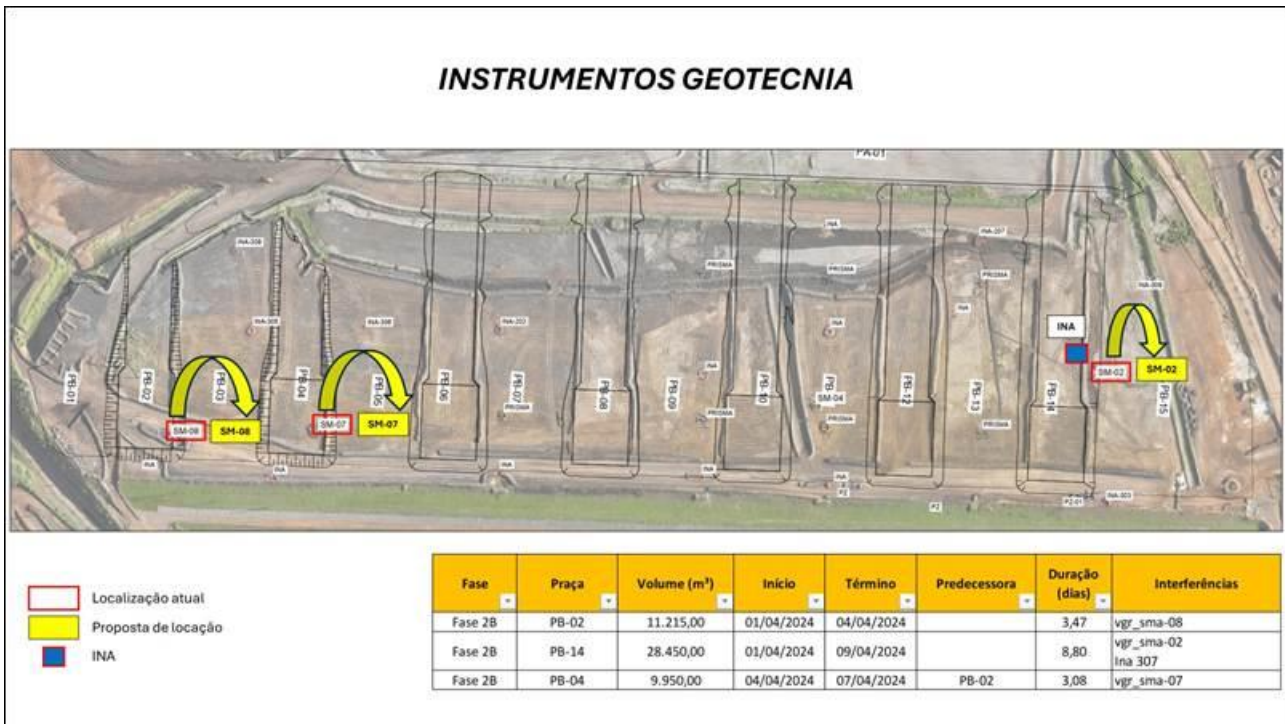
Figura 27. Realocação dos sismógrafos SMA-02, SMA-07 e SMA-08 no dia 28/03/2024 para início das atividades da Fase 02.
