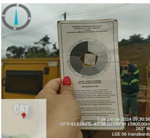
Foto 21. Monitoramento de fumaça preta - Gerador. Fonte: Vale (07/06/2024).
