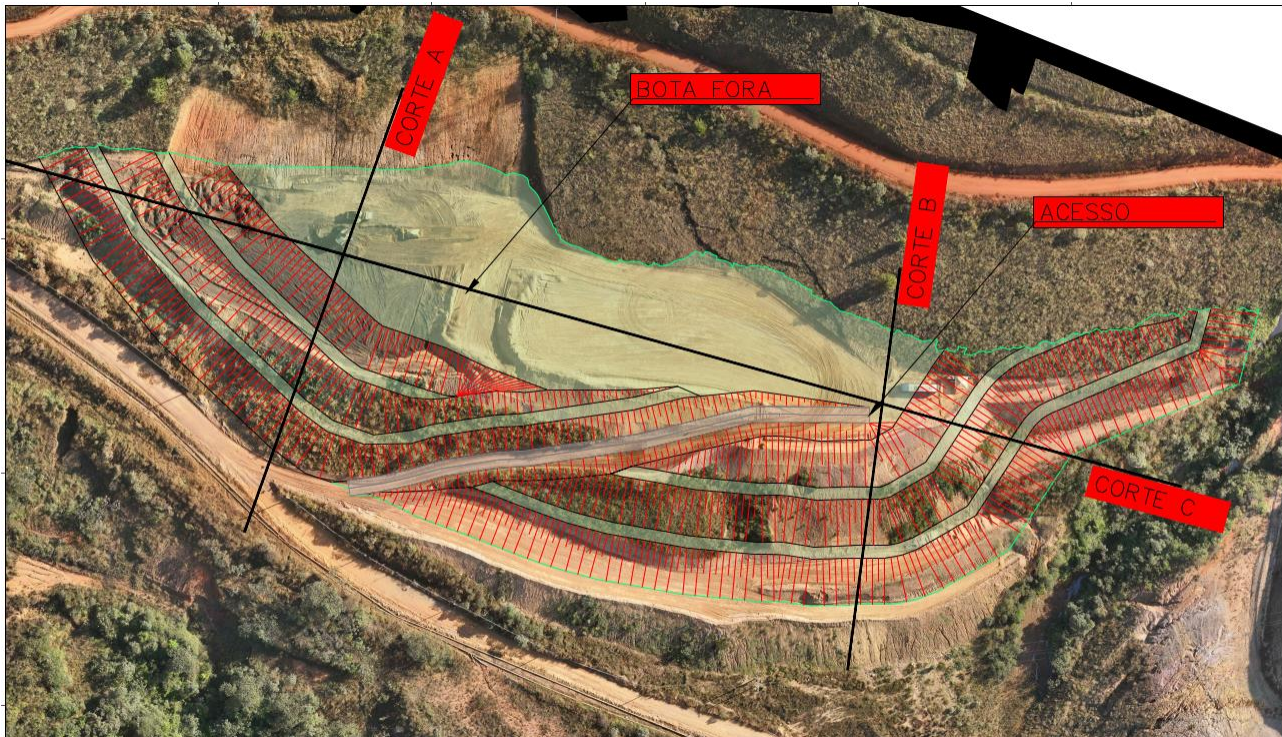
Figura 13. Arranjo geométrico do ADME de Forquilha V (Julho/24).
