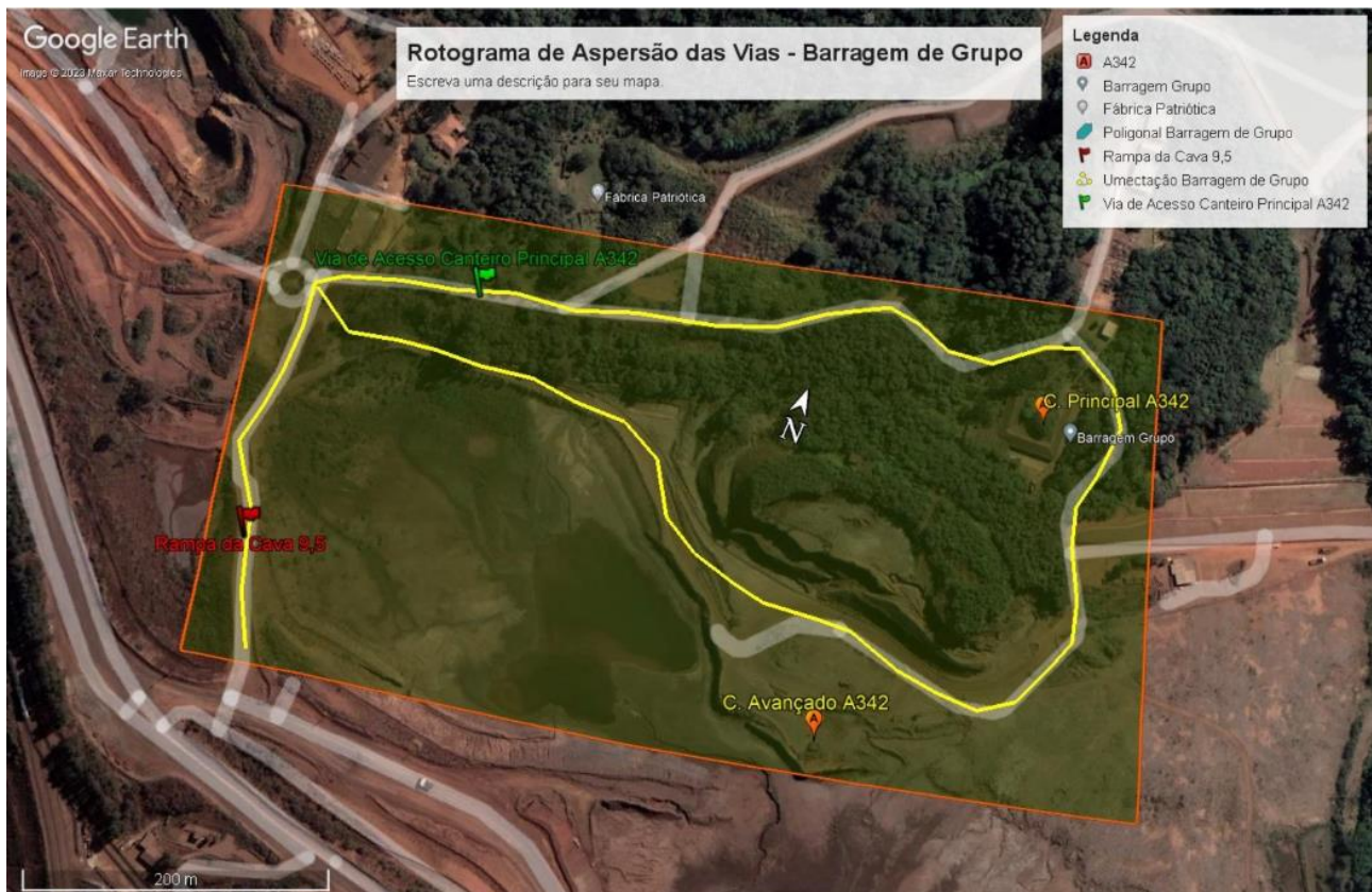
Figura 17. Rotograma de aspersão para as obras de descaracterização da barragem de Grupo, utilizado até maio de 2024 – Construtora Aterpa. Fonte: Vale, 2024.
