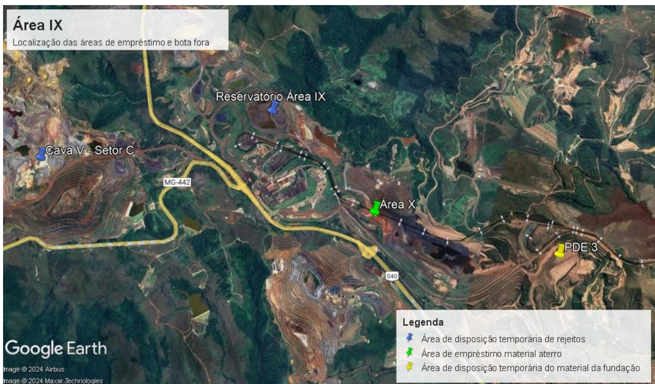
Figura 12. Localização das áreas de empréstimo e bota fora temporário dos rejeitos escavados e material de fundação.
