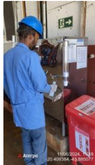
Foto 63. Coleta de água para análise laboratorial (Fonte: Vale, 2024)
