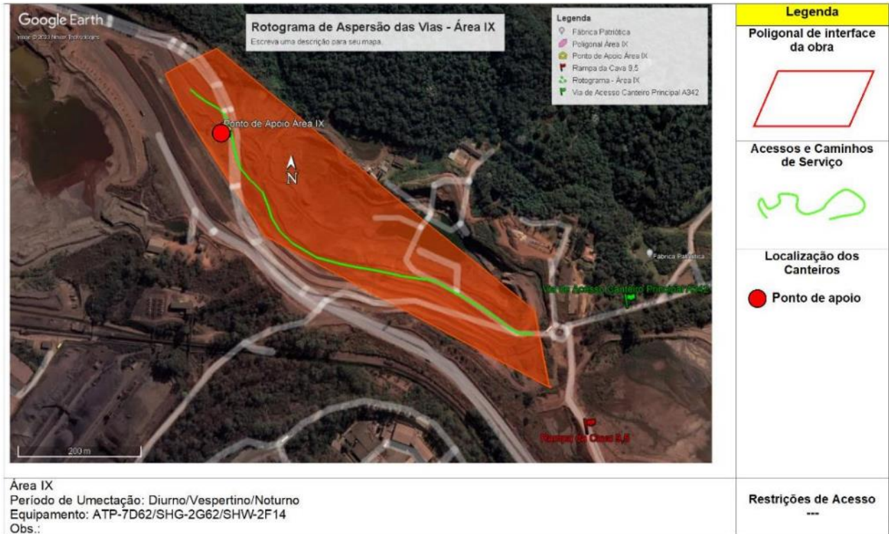
Figura 23. Rotograma de aspersão para as obras de descaracterização da barragem de Área IX, utilizado até maio de 2024 – Construtora Aterpa. Fonte: Vale, 2024.
