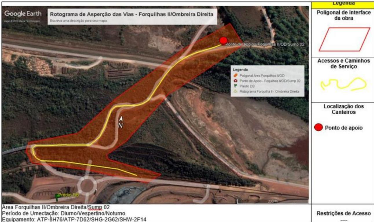
**Figura 26:** Rotograma de aspersão para as obras complementares de descaracterização da barragem de Forquilha II, utilizado até maio de 2024 – Construtora Aterpa. Fonte: Vale, 2024.
