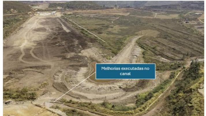
**Foto 26.** Forquilha II – Correção de drenagem danificada – margem direita do reservatório - recomendação F2-0149 e F2-0182 (Julho/24).
