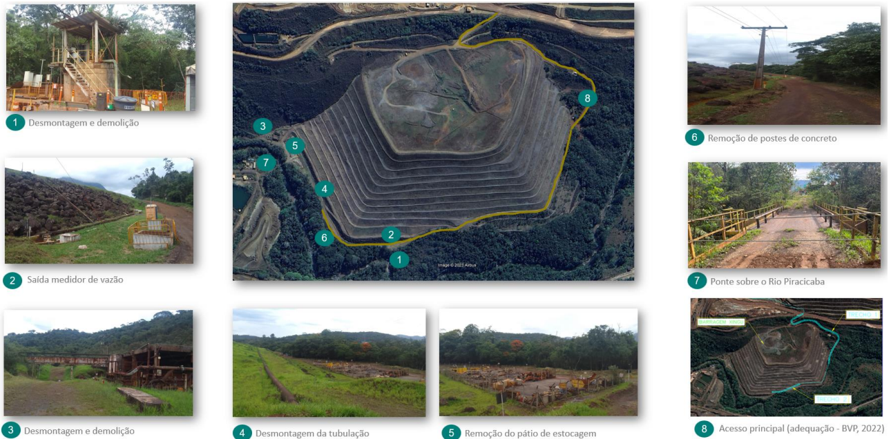
Figura 9. Interferências físicas e acessos construtivos.
