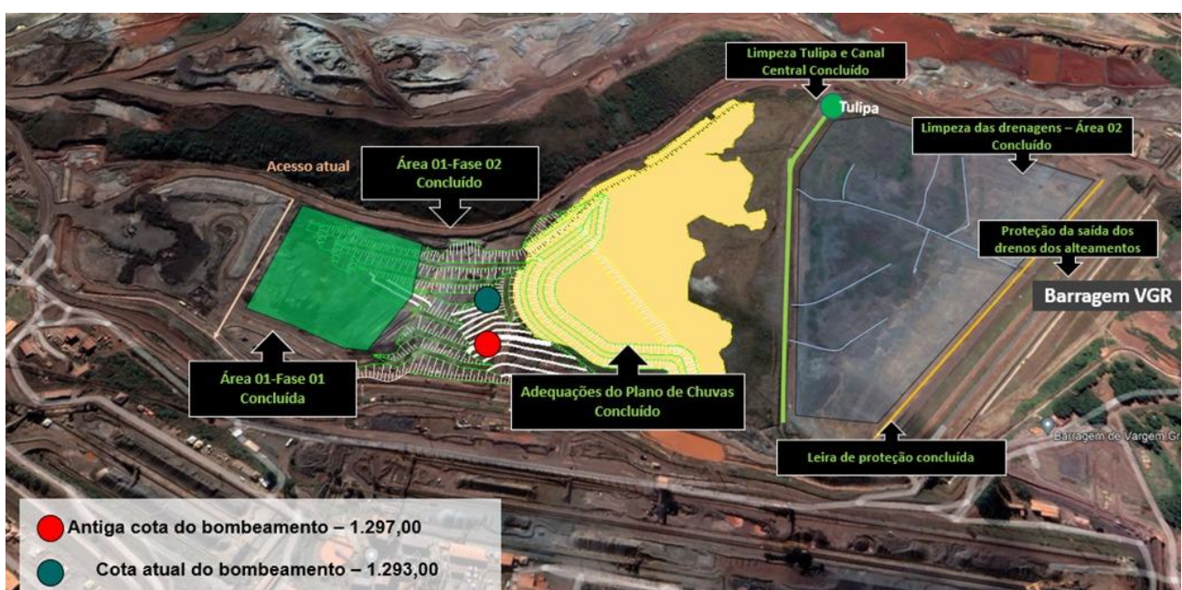
Figura 2. Configuração geral das atividades preliminares ao início das obras de descaracterização.
