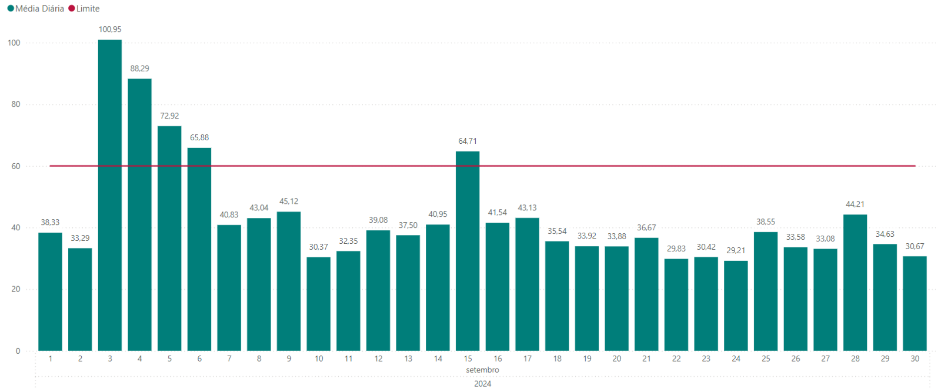
Figura 52 - Monitoramento da Qualidade do Ar na Estação Estância Estoril (PM 2,5), média diária em (µg/m³), em setembro de 2024 (Fonte: Vale, 2024).
