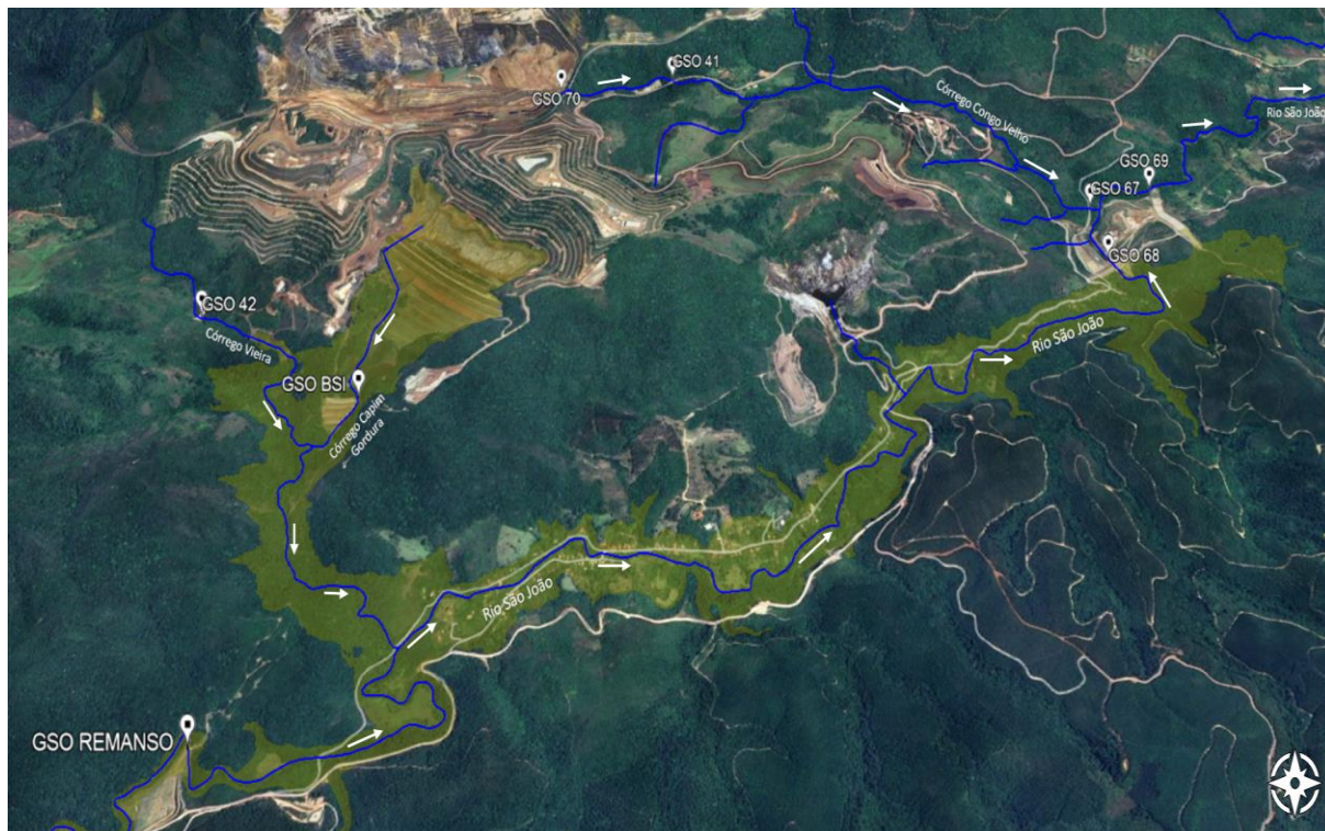
Figura 56 - Mapa da rede de monitoramento do parâmetro turbidez para a obra de descaracterização da barragem Sul Superior. A área indicada na cor “verde” indica os locais de Zona de Autosalvamento da Barragem Sul Superior. Fonte: Vale, 2024.
