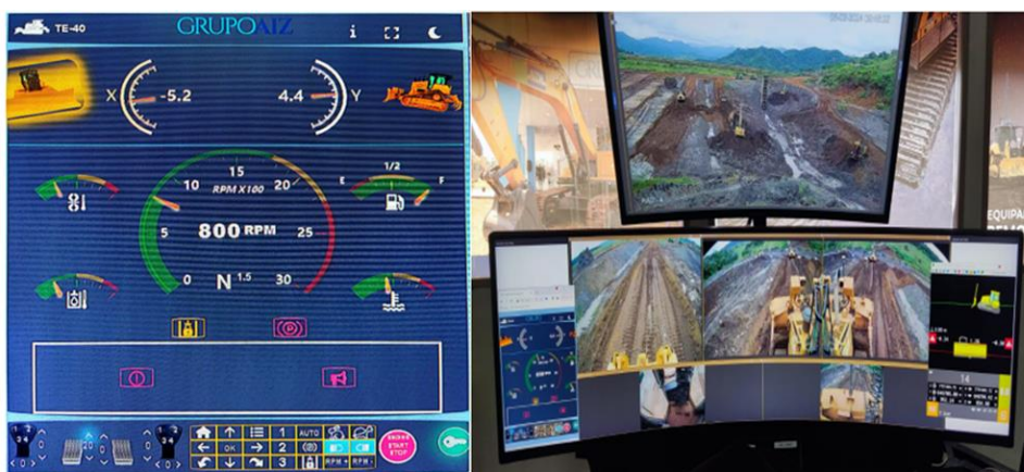
Figura 20 - Monitor do Cockpit de Operação mostrando os principais parâmetros de operação e manutenção.
