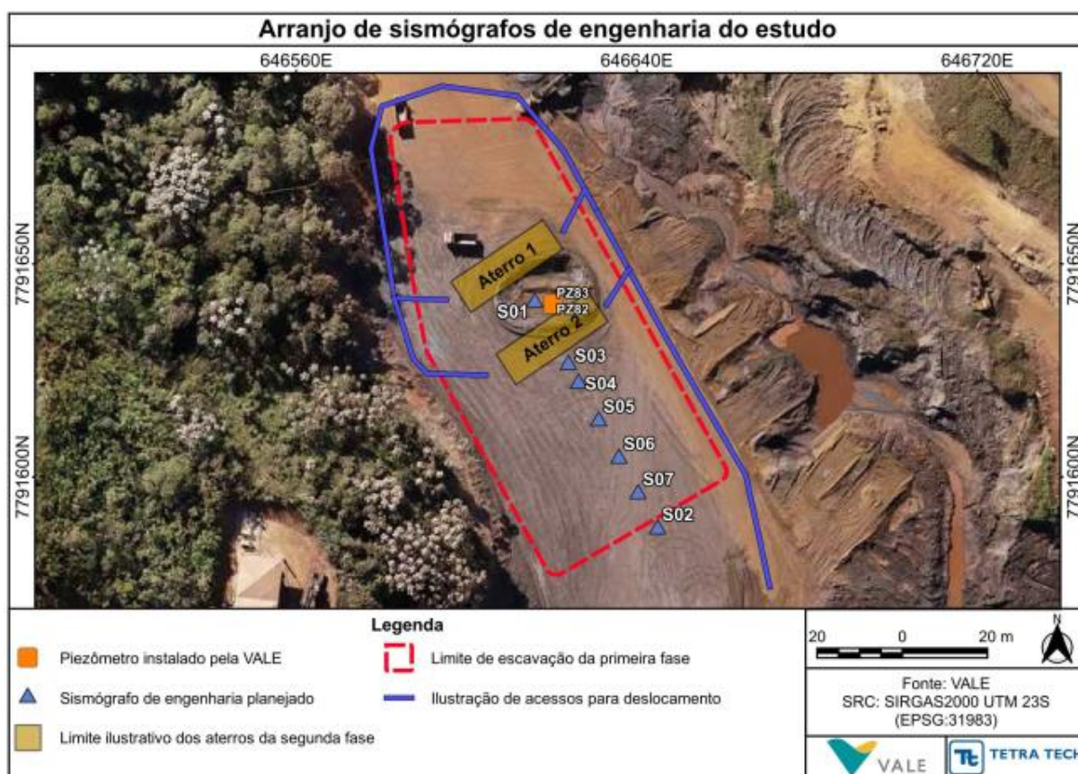
Figura 3 - Arranjo de sensores compostos por sete sismógrafos de engenharia e dois piezômetros.
