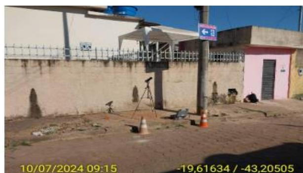
**Figura 193 - Equipamentos utilizados no monitoramento de vibração próximo a área demolida. Bioma, 2024.**
