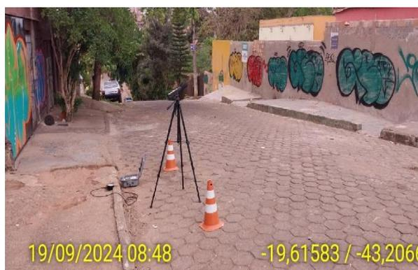
Figura 227 - Equipamentos utilizados no monitoramento de ruído no ponto RV06 próximo à área.
