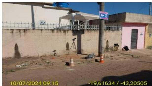
**Figura 269 - Equipamentos utilizados no monitoramento de vibração próximo a área demolida. Bioma, 2024.**
