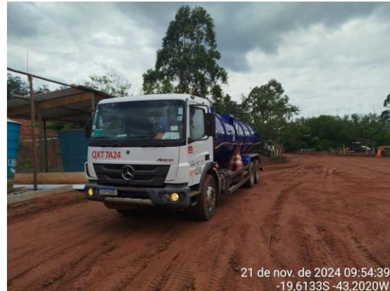
**Figura 184 - Sucção de efluentes armazenados em tanque séptico para armazenamento de efluentes provenientes do canteiro de obras em 21/11/2024. Fonte: Vale, 2024.**
