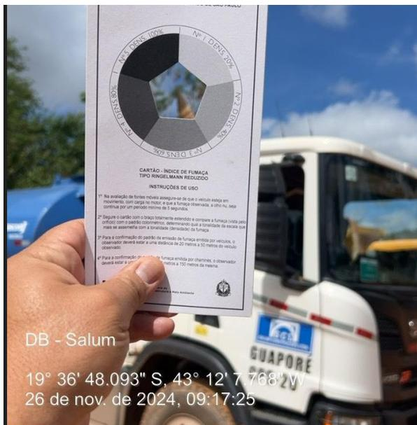
**Figura 47 - Controle de Emissões Proveniente de Escapamento de Equipamentos Movidos a Diesel em 26/11/2024. Fonte: Vale, 2024.**
