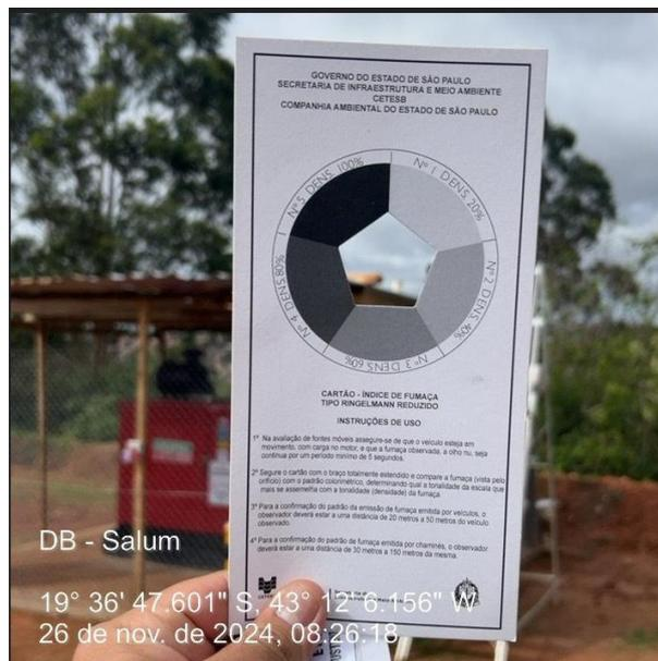
**Figura 48 - Controle de Emissões Proveniente de Escapamento de Equipamentos Movidos a Diesel em 26/11/2024. Fonte: Vale, 2024.**
