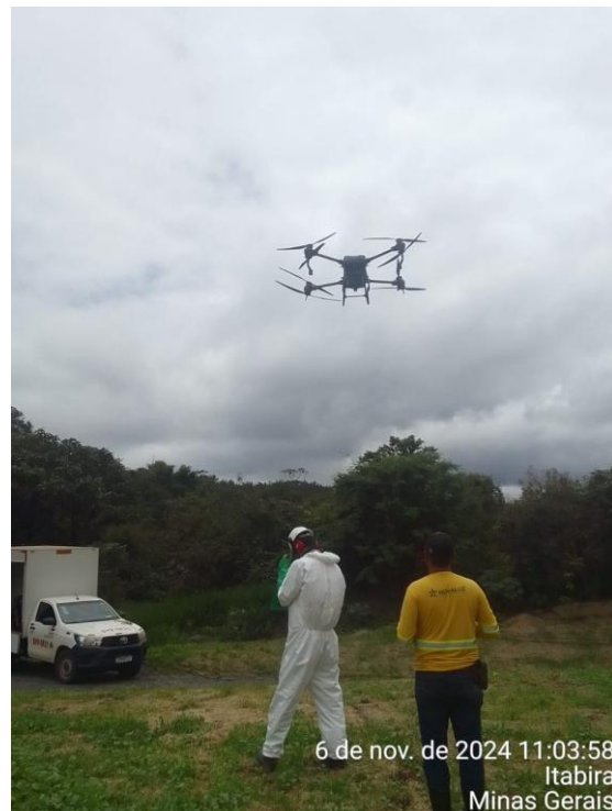
Figura 70 - Aplicação de mistura de calcário para correção do solo na área plana do Dique 1B em 06/11/2024. Fonte: Vale, 2024.
