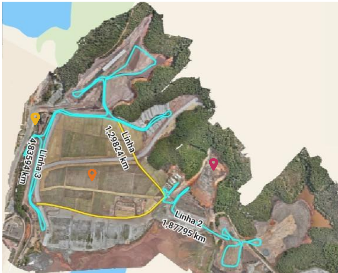
Figura 50 - Rotograma de umectação de vias e de aplicação de polímero supressor de poeira nas principais vias de acesso às obras de descaracterização do Dique 1A e 1B adotado até novembro. Fonte: Vale, 2024.
