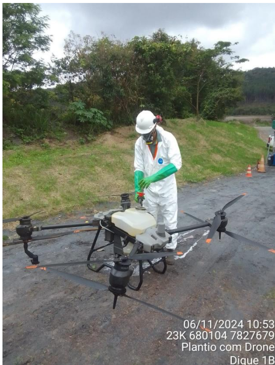
Figura 69 - Abastecimento Tanque de Drone para aplicação de mistura de calcário para correção do solo. Fonte: Vale, 2024.
