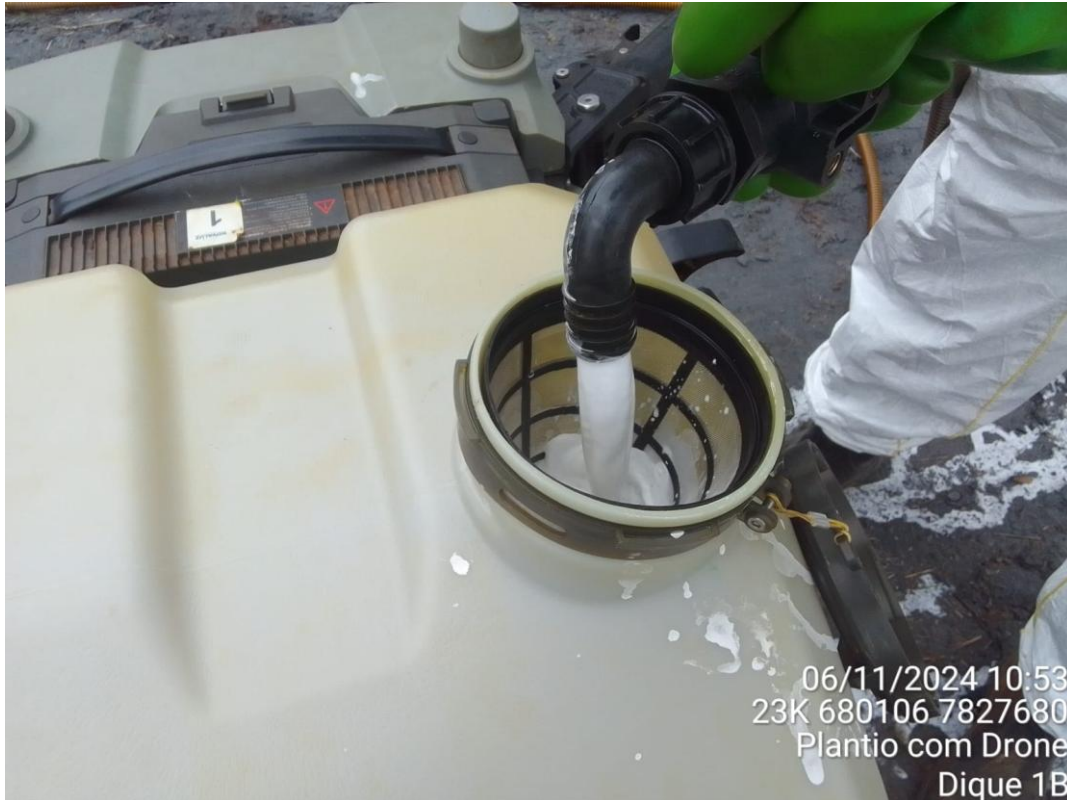
Figura 68 - Abastecimento Tanque de Drone para aplicação de mistura de calcário para correção do solo. Fonte: Vale, 2024.
