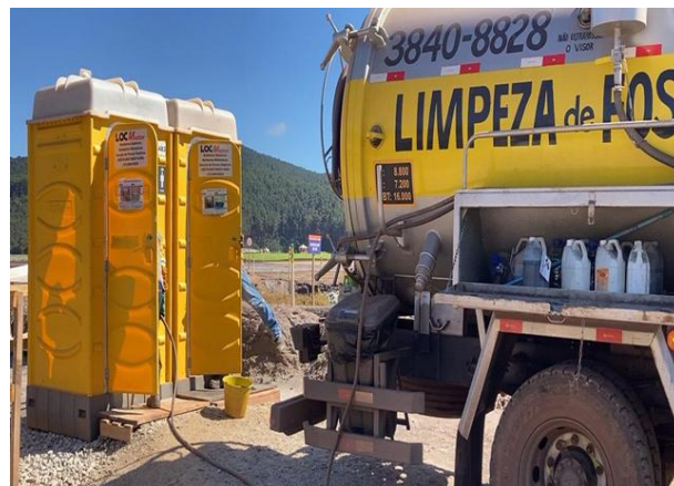
Figura 54 - Evidências de Limpeza dos banheiros químicos e sucção de efluentes sanitários. Fonte: Vale, 2024.
