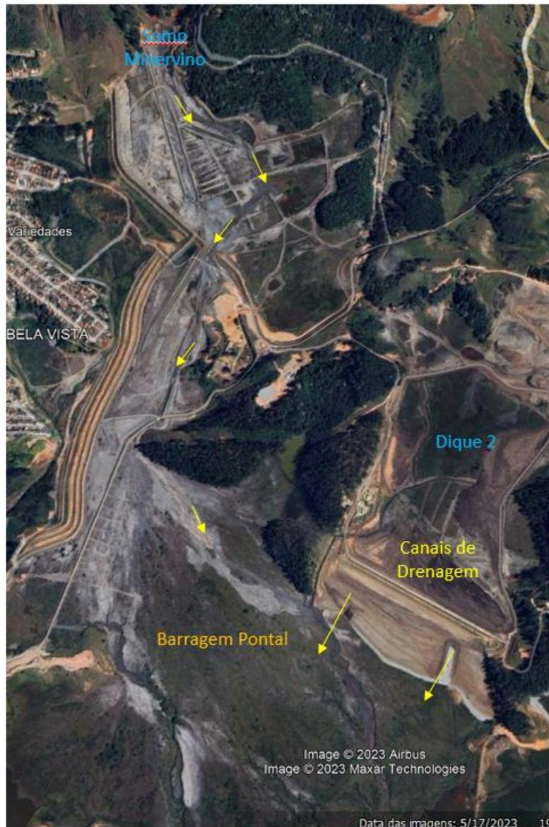
**Figura 32:** Localização do Dique 2, Sump Minervino e direcionamento das drenagens para a Barragem Pontal. Fonte: Vale, 2023.
