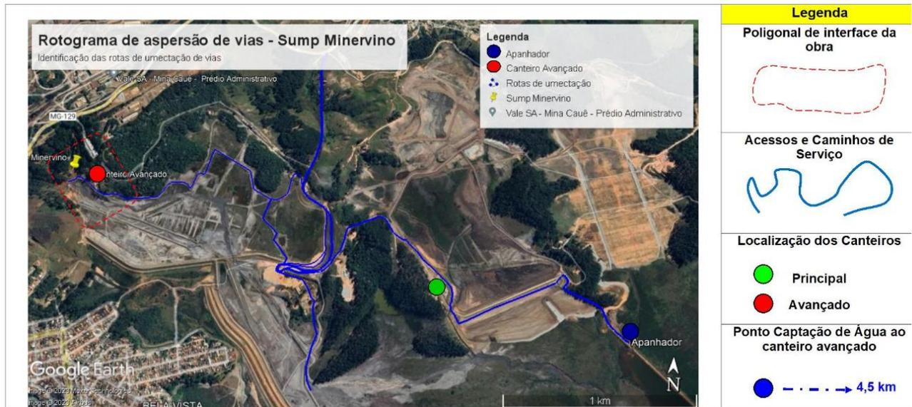
**Figura 25:** Rotograma utilizado para umectação das vias na obra do SUMP Minervino. Fonte: Vale, 2023.
