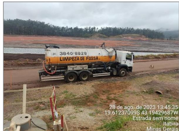
**Foto 28:** Limpeza com sucção do tanque séptico. Fonte: Vale, 2023.
