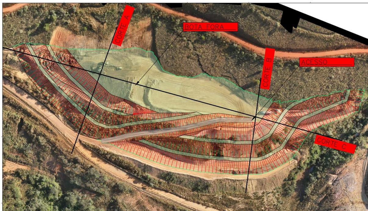
Figura 35 - Arranjo geométrico do ADME de Forquilha V
