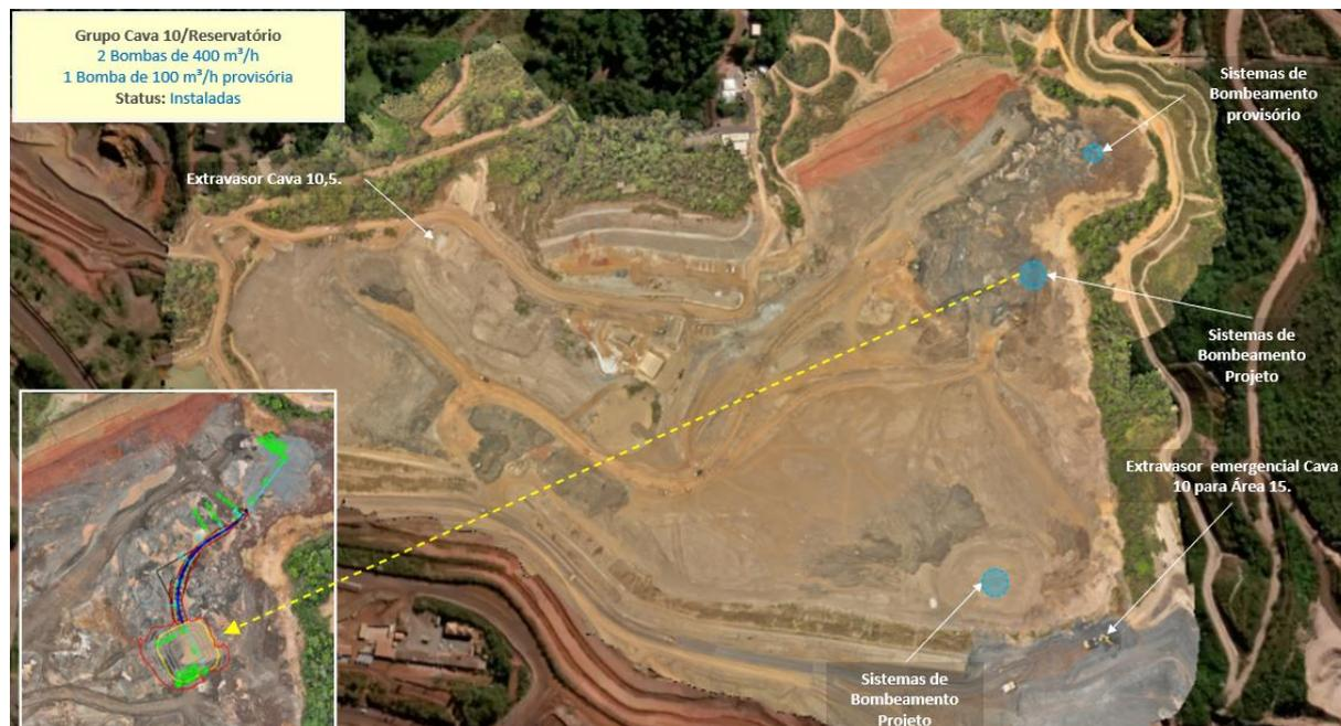
Figura 10 - Sistemas de bombeamento implantados no período
