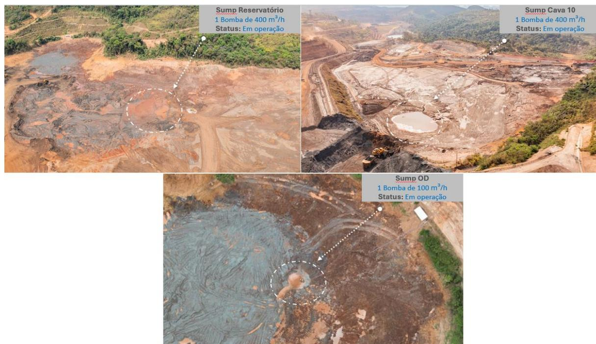
Figura 11 – Detalhamento sistema de bombeamento – Reservatório, Cava 10 e OD
