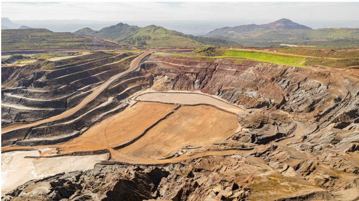
Figura 24 - Disposição final em aterro compactado do rejeito de Grupo na Cava 5 (janeiro/25).
