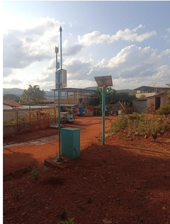
Figura 74 - Estação de Monitoramento de Ruído de Mota. Vale, 2023.
