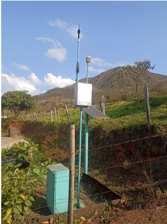
Figura 73 - Estação de Monitoramento de Ruído de Pires. Vale, 2023.
