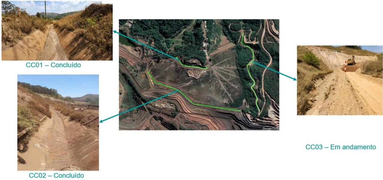
**Figura 6.** Manutenção dos canais de cintura.
