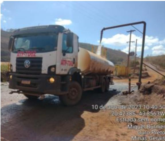
**Foto 36.** Captação de água com caminhão pipa para umectação das vias (Fonte: Vale, agosto, 2023)
