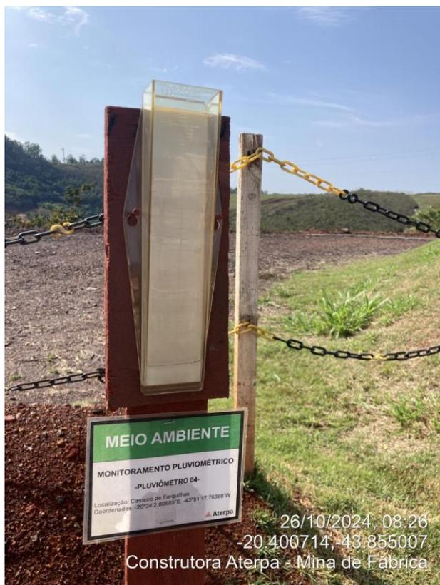
Figura 72 - Pluviômetro do canteiro de obras da construtora Aterpa (Canteiro Forquilhas). Vale, 2024.
