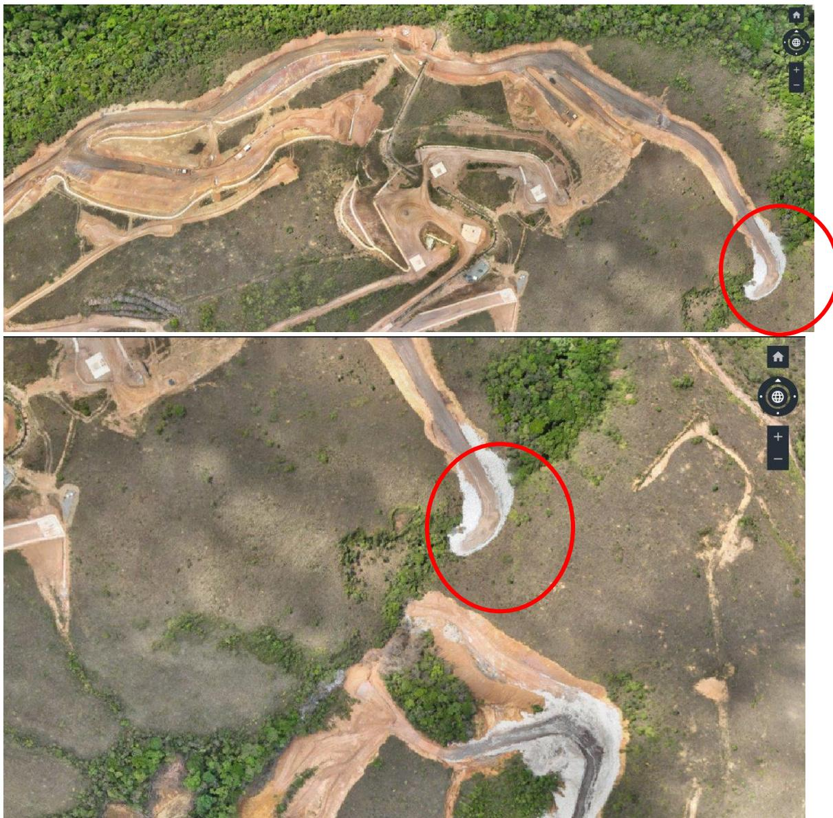
Figura 56 e Figura 57 - Execução do aterro drenante a jusante da barragem de Forquilha III.
