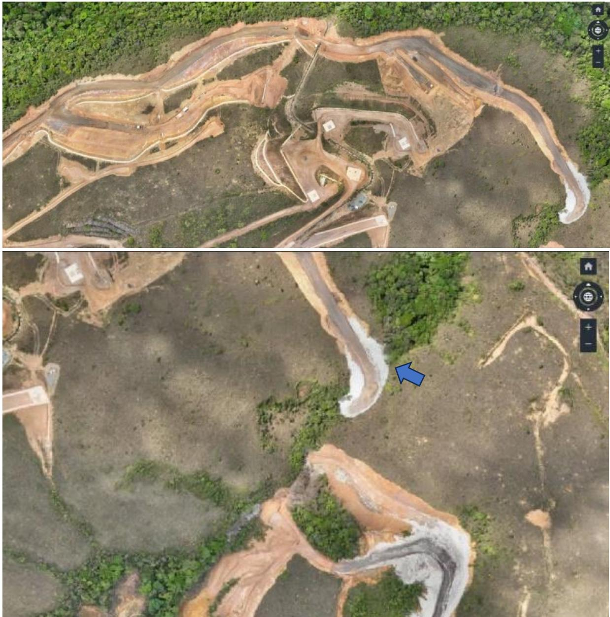
Figura 60 e Figura 61 - Medidas de controle implantadas para a manutenção do fluxo do corpo hídrico a jusante da barragem. Fonte: Vale, 2024.
