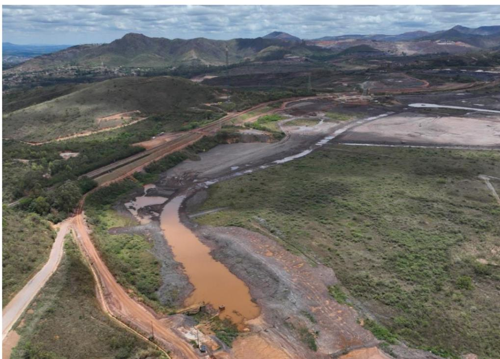
**Figura 42 - Remoção de material entre Sump 3 (Dique Ponto 1) e Torres do Extravasor - Recomendação F3-0320 (Outubro/24).**
