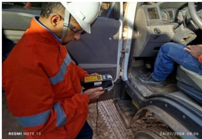
Figura 74 - Medição de fumaça emitido pelo escapamento de veículos e equipamentos movidos a diesel por Opacímetro. Fonte: Vale, 2024.
