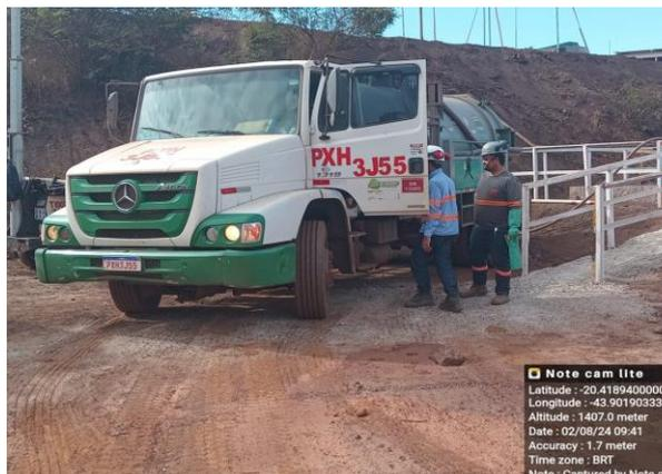
**Figura 101 - Sucção de efluente sanitário armazenado nos tanques sépticos (Fonte: Vale, julho de 2024).**
