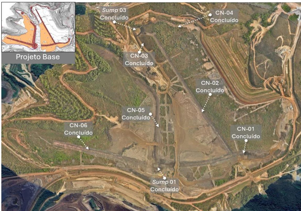
Figura 24 - Avanço das escavações dos canais e sumps do PPC 24/25 – Projeto INTT (Outubro/2024)
