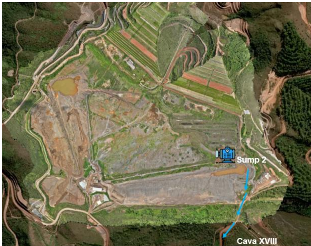
Figura 114: Esquema do bombeamento realizado na barragem de Forquilha II. Vale, 2025.
