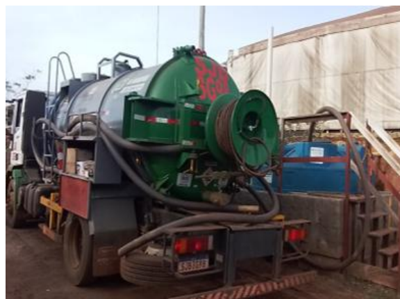
Figura 100 - Sucção de efluente sanitário armazenado nos tanques sépticos, novembro de 2024 (Fonte: Vale, 2024).
