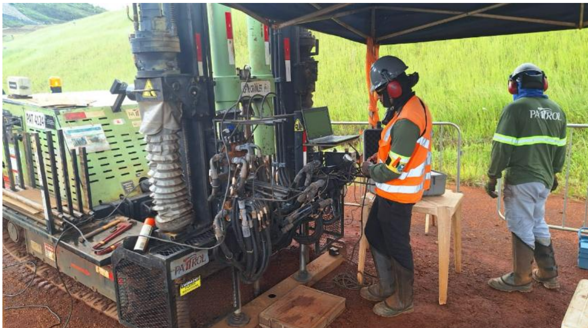
Figura 10 - Forquilha II – Sondagem CPTU Forquilha II –Campanha EOR (Janeiro/25).
