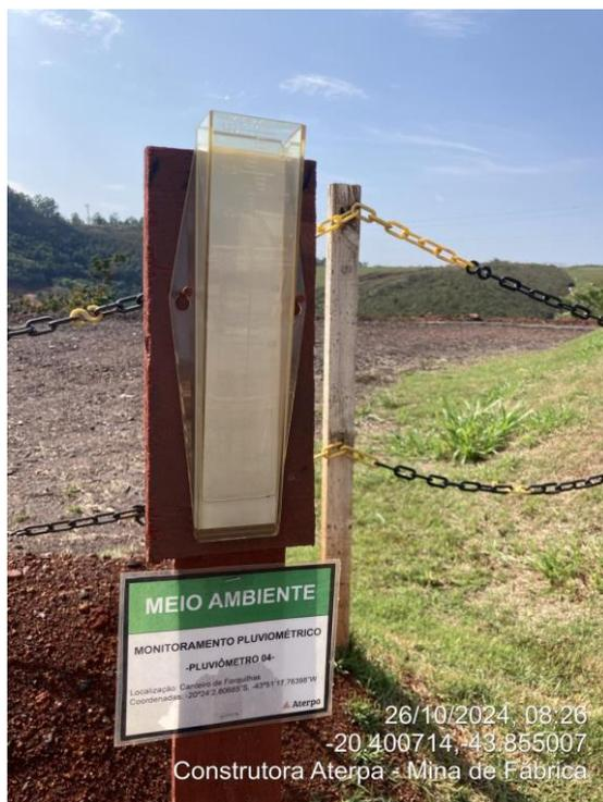
**Figura 57 - Pluviômetro do canteiro de obras da construtora Aterpa (Canteiro Forquilhas). Vale, 2024.**
