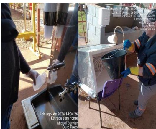
**Figura 106 - Coleta de água para Análise de potabilidade no bebedouro no Canteiro Forquilhas. Fonte: Vale, agosto 2024.**
