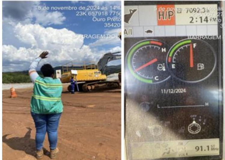
**Figura 51 - Monitoramento de emissão atmosférica escavadeira hidráulica EH-08 realizada no dia 05/11/2024. Fonte: Vale, 2025.**
