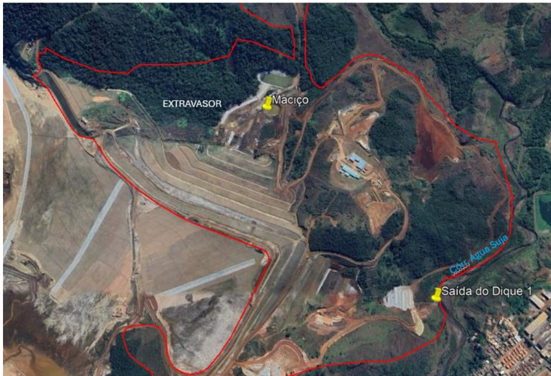
Figura 47 - Localização dos pontos de monitoramento diário de efluentes, para o parâmetro turbidez, no maciço principal e dique 1.
