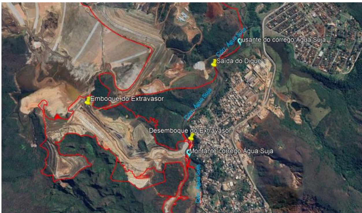
Figura 51 - Localização dos pontos de monitoramento do parâmetro turbidez no córrego Água Suja, a montante e jusante do deságue de efluentes.
