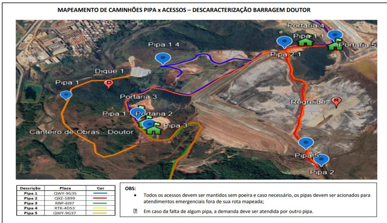
Figura 11. Rotograma das áreas de umectação para obras de descaracterização da barragem Doutor. Fonte: Vale, 2024.
