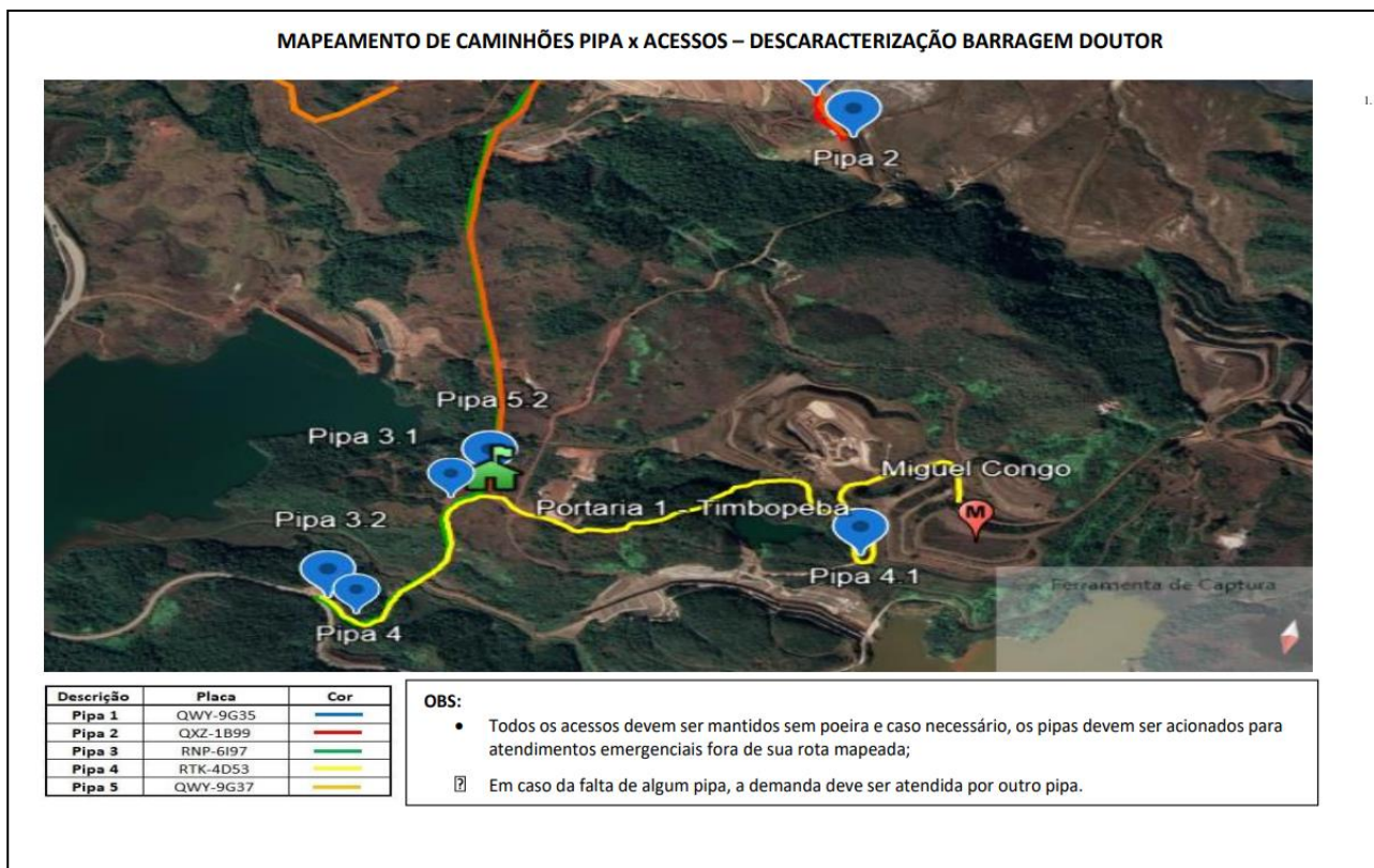
Figura 10. Rotograma das áreas de umectação para obras de descaracterização da barragem Doutor. Fonte: Vale, 2024.
