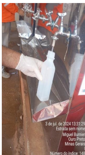
Figura 102 - Coleta de água para análise laboratorial (Fonte: Vale, 2024)
