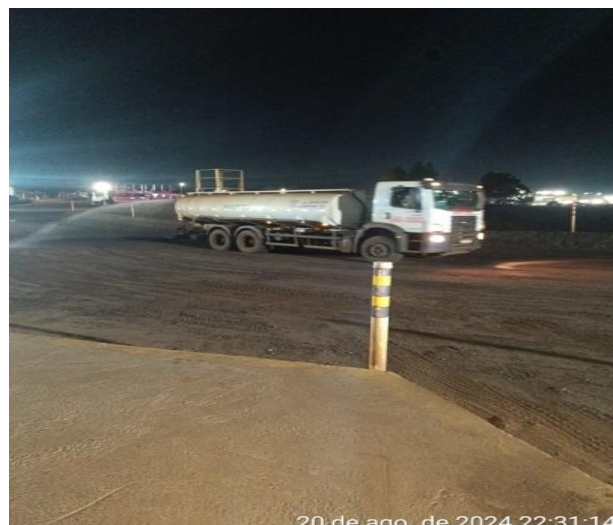
Figura 46 - Caminhão pipa realizando aspersão das vias. Fonte: Vale, agosto de 2024.
