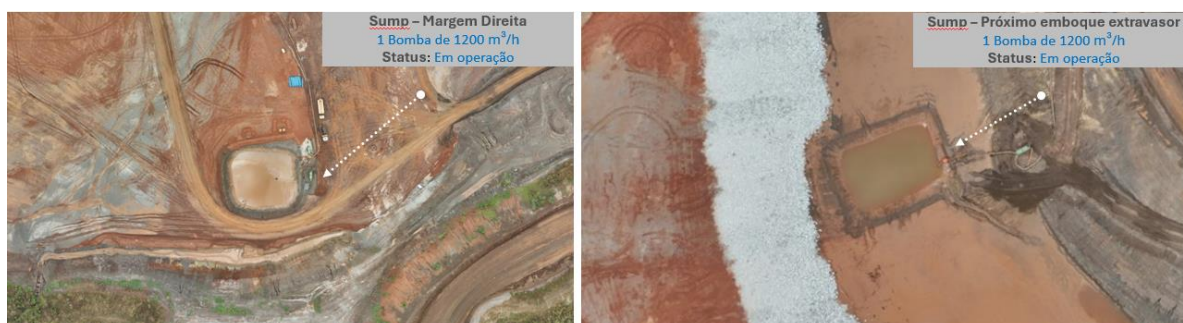
Figura 99 - Sumps equipados com sistema de bombeamento em operação na Área IX. Vale, 2024.
