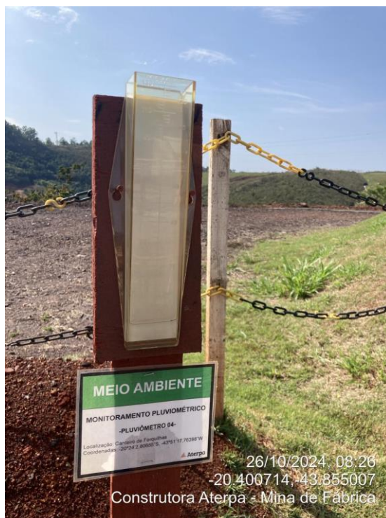
Figura 55 - Pluviômetro do canteiro de obras da construtora Aterpa (Canteiro Forquilhas). Vale, 2024.
