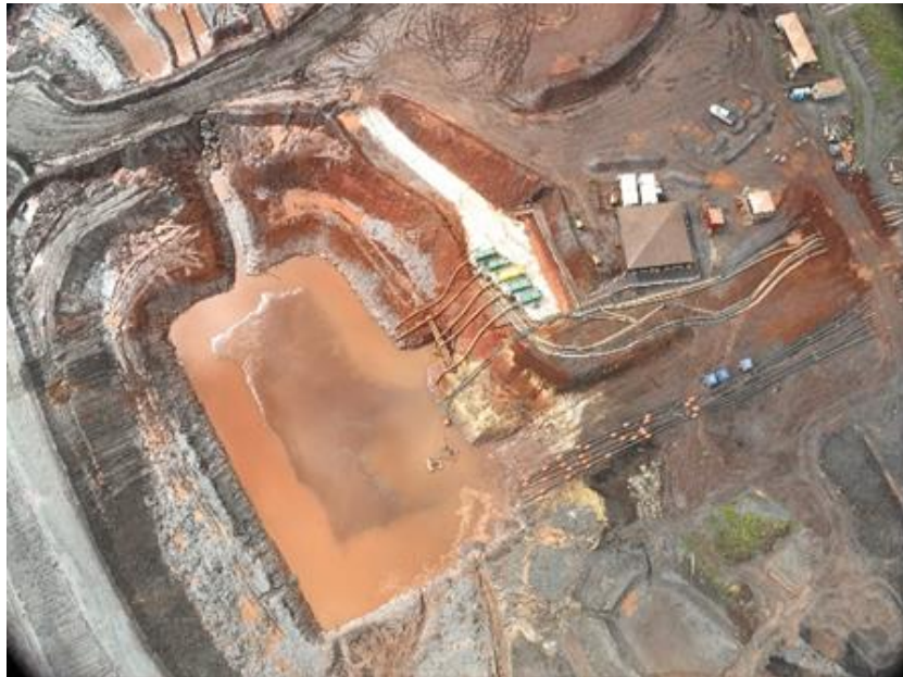
Foto 26. Nova geometria do Sump interno de Vargem Grande após execução da expansão do sistema. (Fonte: Vale, 2023)
