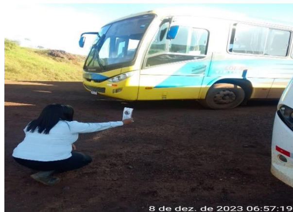
Foto 18: Monitoramento de fumaça preta dos veículos e equipamentos das frentes de serviço. (Fonte: Vale 2023)
