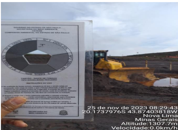
Foto 17: Monitoramento de fumaça preta dos veículos e equipamentos das frentes de serviço. (Fonte: Vale 2023)
