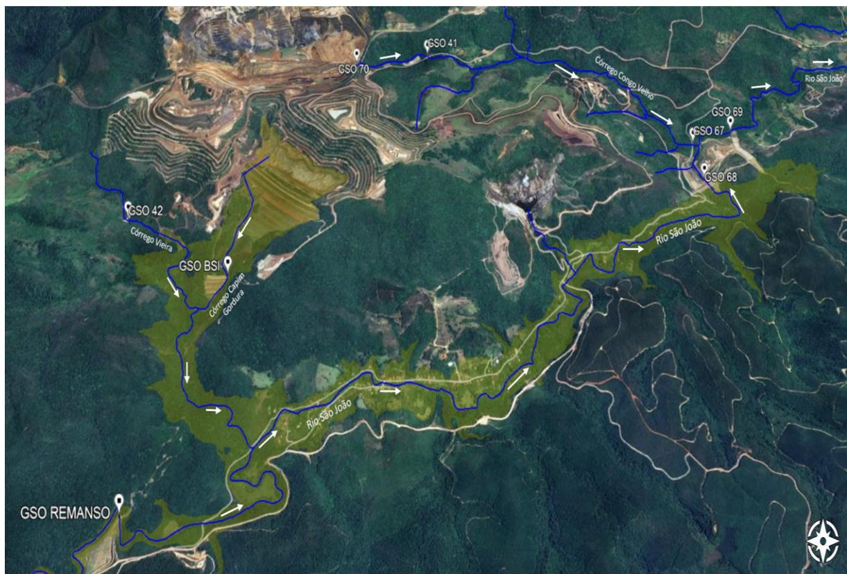
**Figura 67 - Mapa da rede de monitoramento do parâmetro turbidez para a obra de descaracterização da barragem Sul Superior. A área indicada na cor “verde” indica os locais de Zona de Autosalvamento da Barragem Sul Superior. Fonte: Vale, 2024.**
