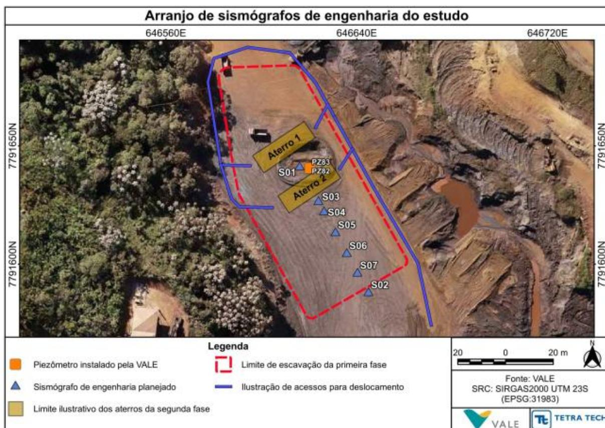
**Figura 5 - Arranjo de sensores compostos por sete sismógrafos de engenharia e dois piezômetros.**
