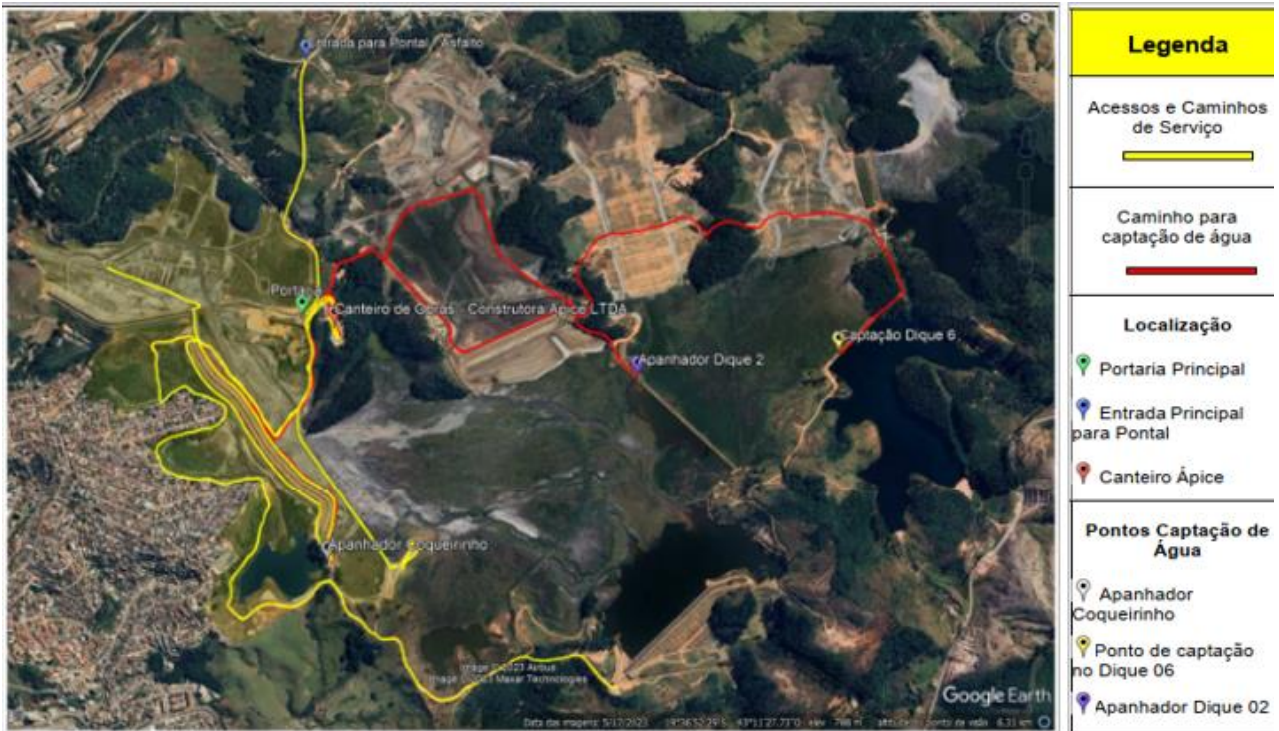
Figura 13. Rotograma utilizado para umectação das vias na obra do Dique 2 e Sump do Dique Minervino. Fonte: Vale, 2024.
