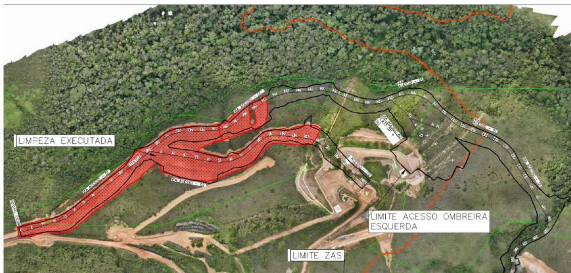
Figura 4: Obras de implantação do acesso construtivo na ombreira esquerda de Forquilha III (abril/24)
