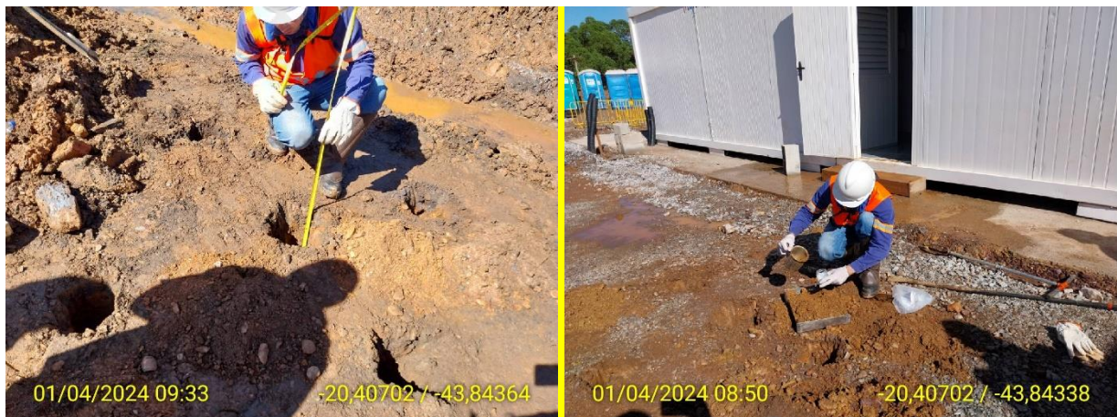
Foto 62 e Foto 63: Amostragem de solo na área do novo canteiro da construtora Barbosa Melo. PT-01, à esquerda, e PT-02 à direita. Fonte: Vale, 2024.
