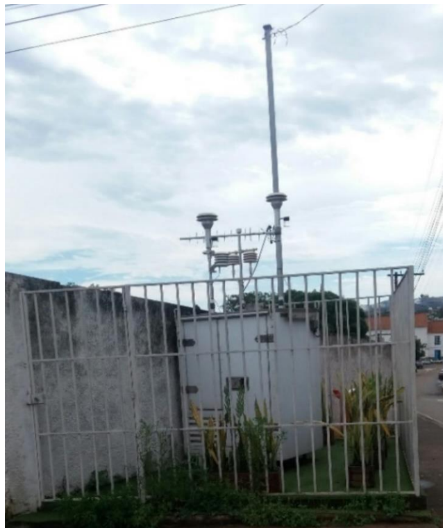
Foto 47: Estação de monitoramento de Qualidade do Ar - Matriz. Fonte: Vale, 2024
