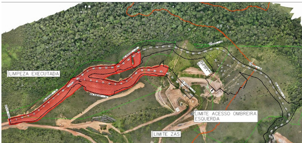
Figura 21: Obras de implantação do acesso construtivo na ombreira esquerda de Forquilha III (abril/24)
