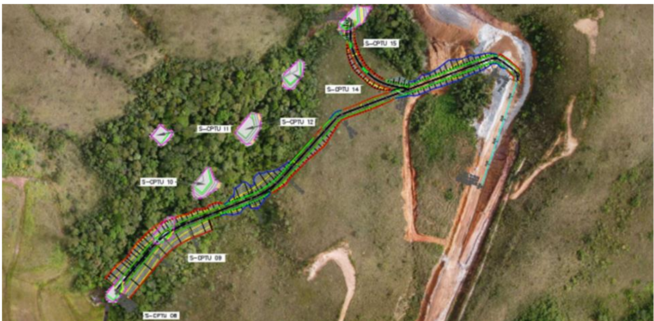
Figura 44: Readequação do acesso à jusante da barragem de Forquilha III – Metodologia com uso de trator e escavadeira sobre esteira (fonte: Vale, 2024).
