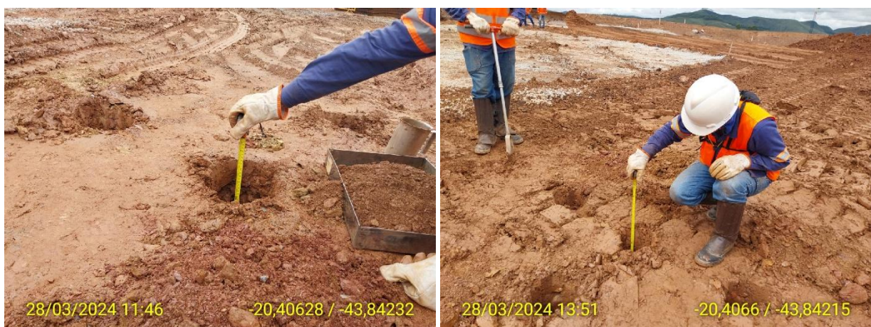
Foto 66 e Foto 67: Amostragem de solo na área do novo canteiro da construtora Barbosa Melo. PT-05, à esquerda, e PT-06 à direita. Fonte: Vale, 2024.
