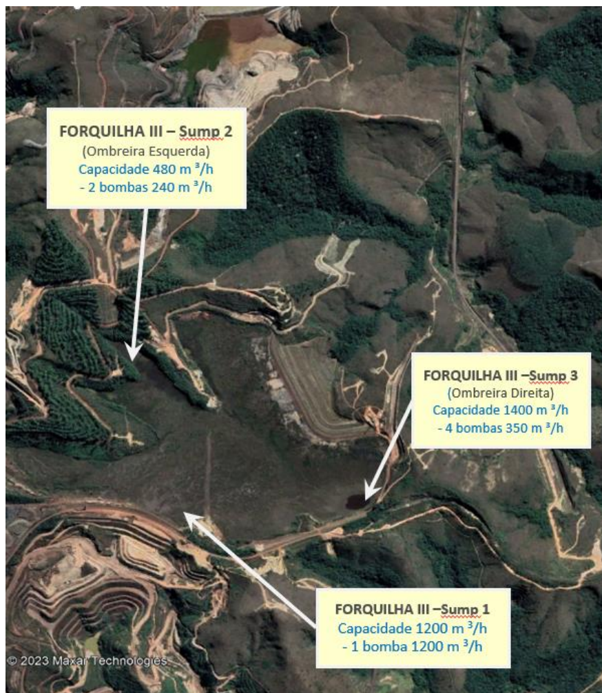
Figura 6: Sistema de bombeamento atual de Forquilha III.
