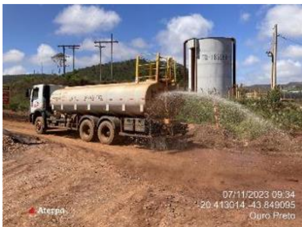
Foto 22. Atividades de aspersão das vias, ombreira esquerda de Forquilha I. Fonte: Vale, novembro, 2023.
