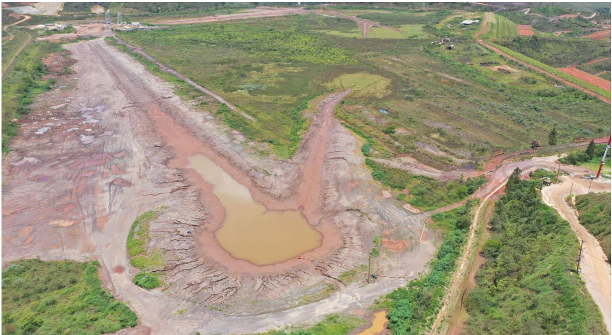
Foto 1. Forquilha II – Canal do teste piloto e canal do plano de chuva – em operação (janeiro/23).
