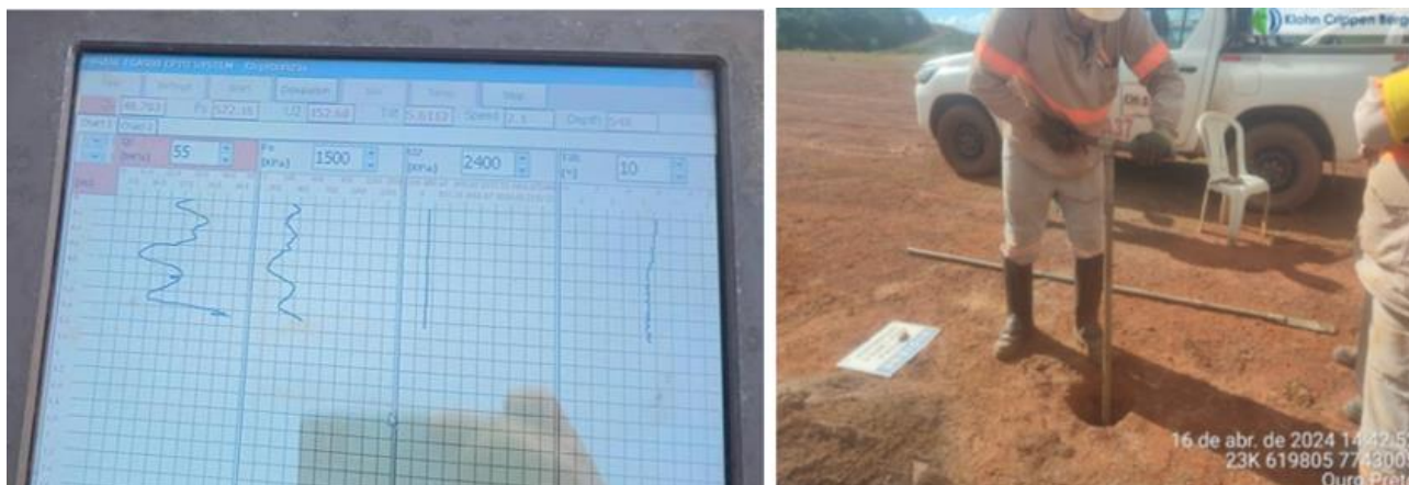
Foto 25. Forquilha I – Teste de CPTU – empresa Chammas (Abril/24).
