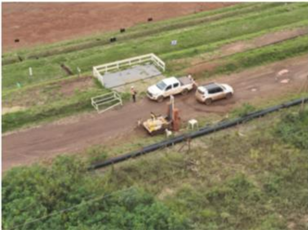
Foto 24. Forquilha I – Teste de CPTU – empresa Chammas (Abril/24).
