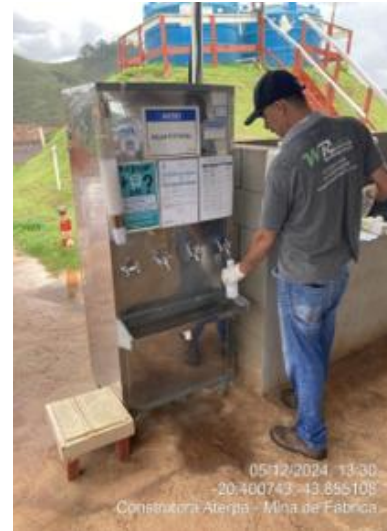
Figura 133 - Coleta de água para análise de potabilidade (Fonte: Vale, dezembro de 2024)
