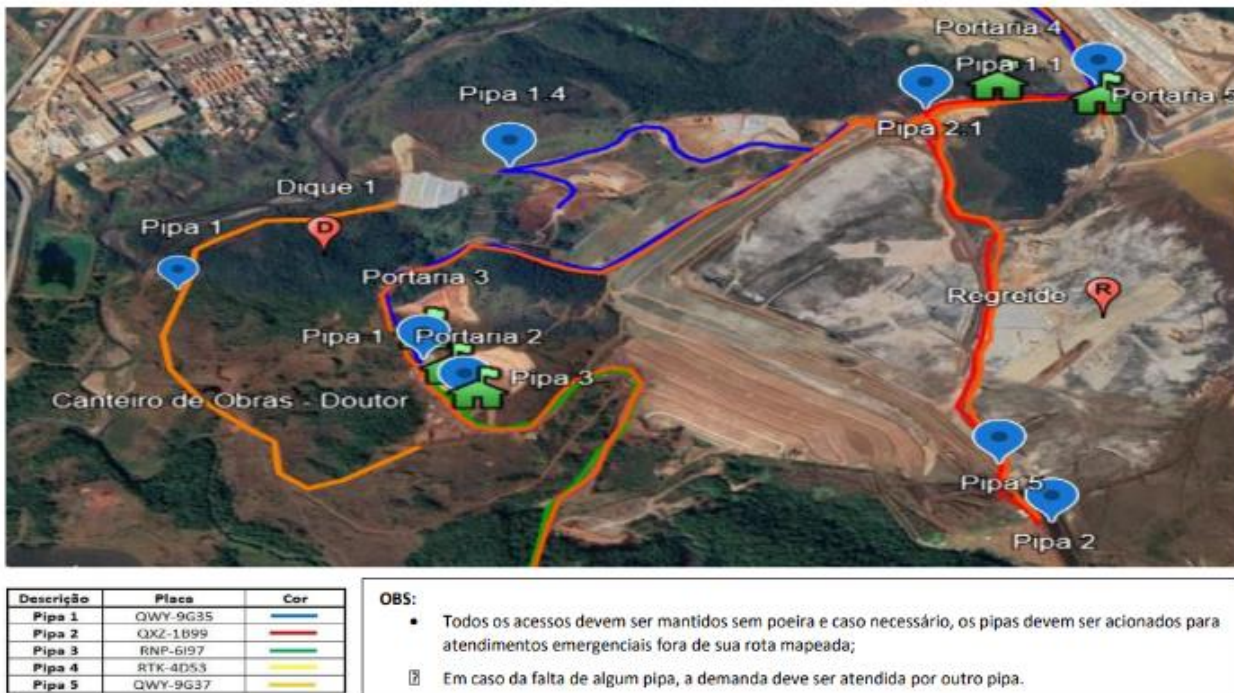
Figura 9. Rotograma das áreas de umectação para obras de descaracterização da barragem Doutor.
