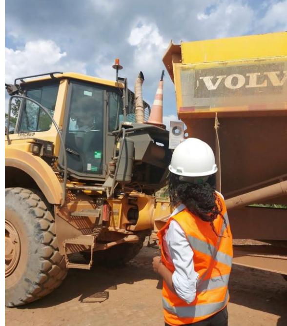
Foto 35 e Foto 36: ilustra o controle das emissões provenientes dos escapamentos dos equipamentos movidos a diesel em operação nas obras da barragem Campo Grande. Fonte: Vale, 2024.
