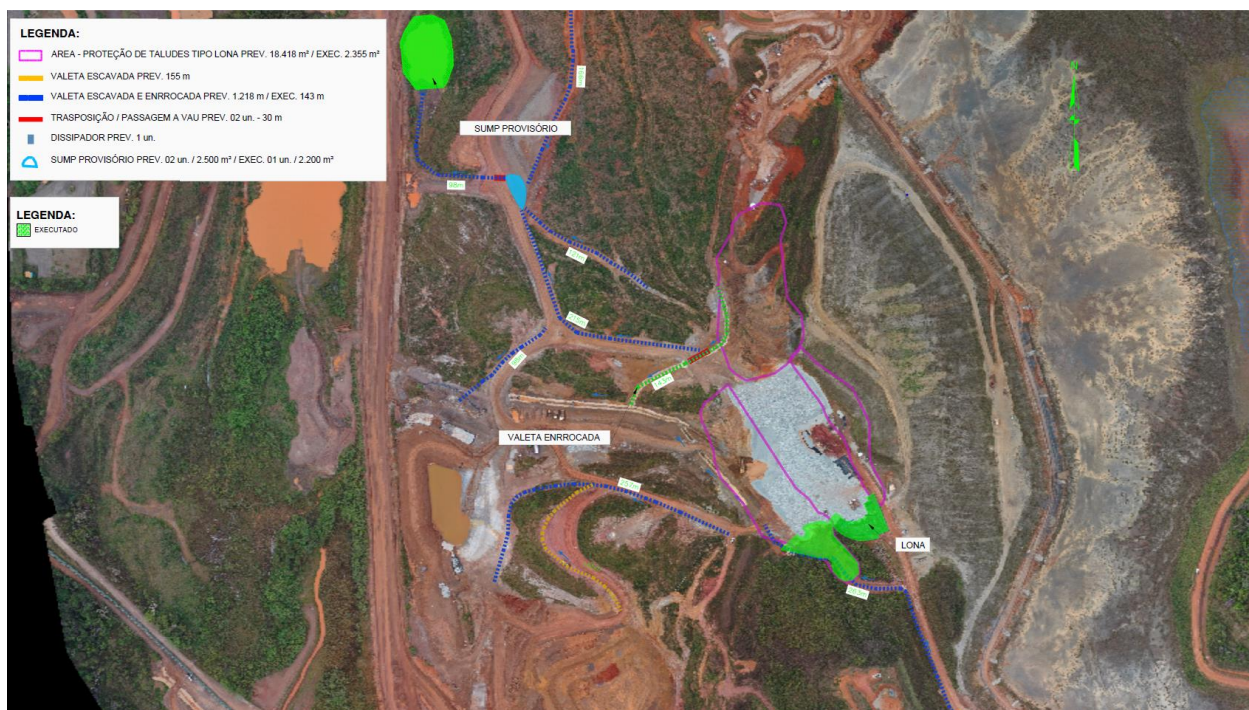
Figura 5: Plano de chuva executado no Dique Norte Sul.
