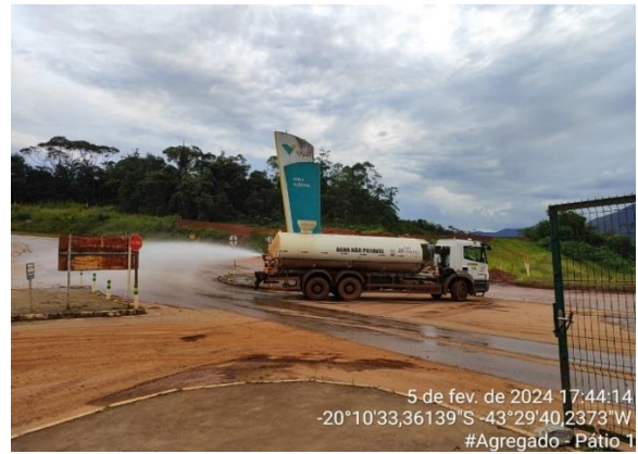
Foto 33 e Foto 34. Umetecação de vias no acesso principal e no pátio de agregado. Fonte: Vale, 2024.
