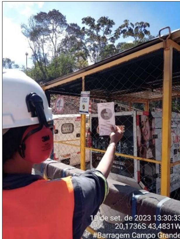
**Foto 37.** Controle das emissões atmosféricas de equipamentos movidos a diesel utilizando a escala de Ringelmann.
