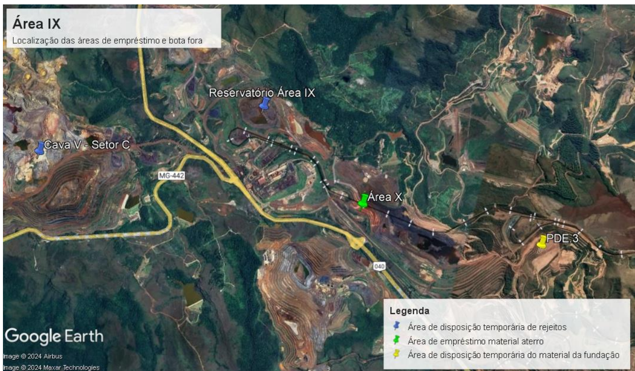
Figura 11. Localização das áreas de empréstimo e bota fora temporário dos rejeitos escavados e material de fundação.
