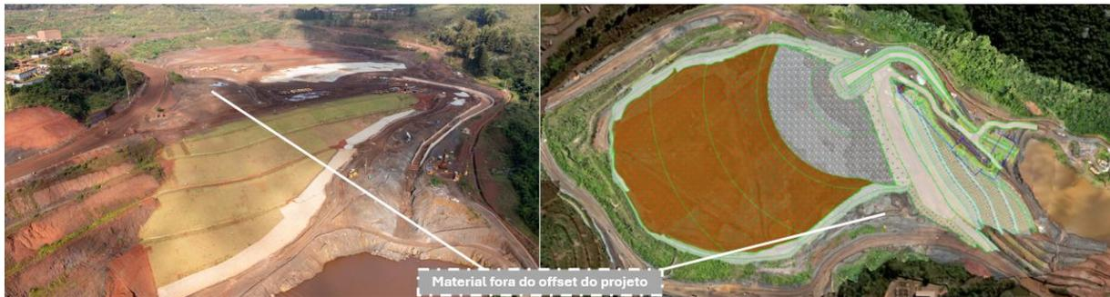
**Figura 16 - Vista da crista pós remoção dos alteamentos (Janeiro/25)**
