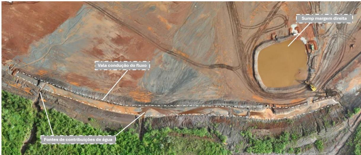
**Figura 33 - Contribuições e surgências na margem direita do reservatório (Janeiro/25)**
