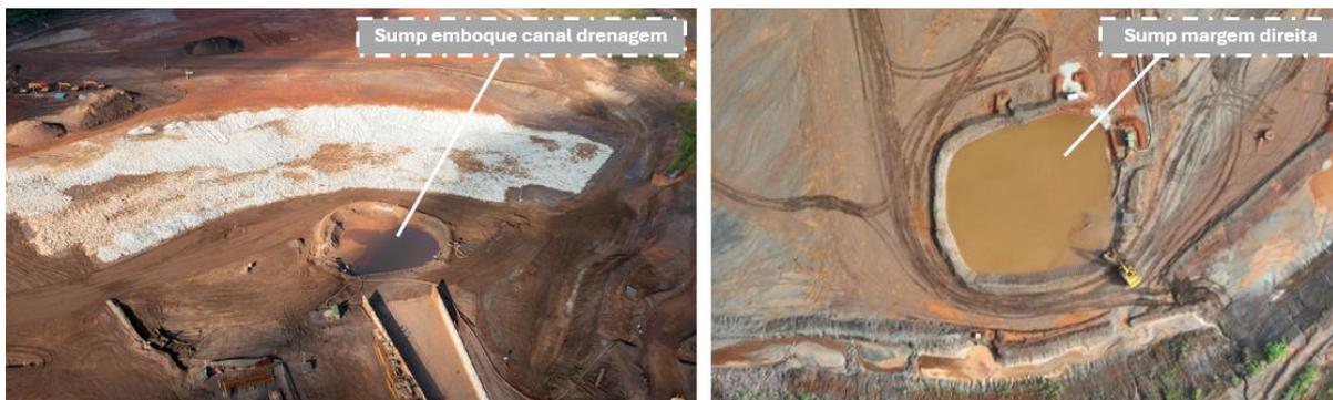
**Figura 139 - Sumps equipados com sistema de bombeamento em operação na Área IX (janeiro/25). Vale, 2025.**
