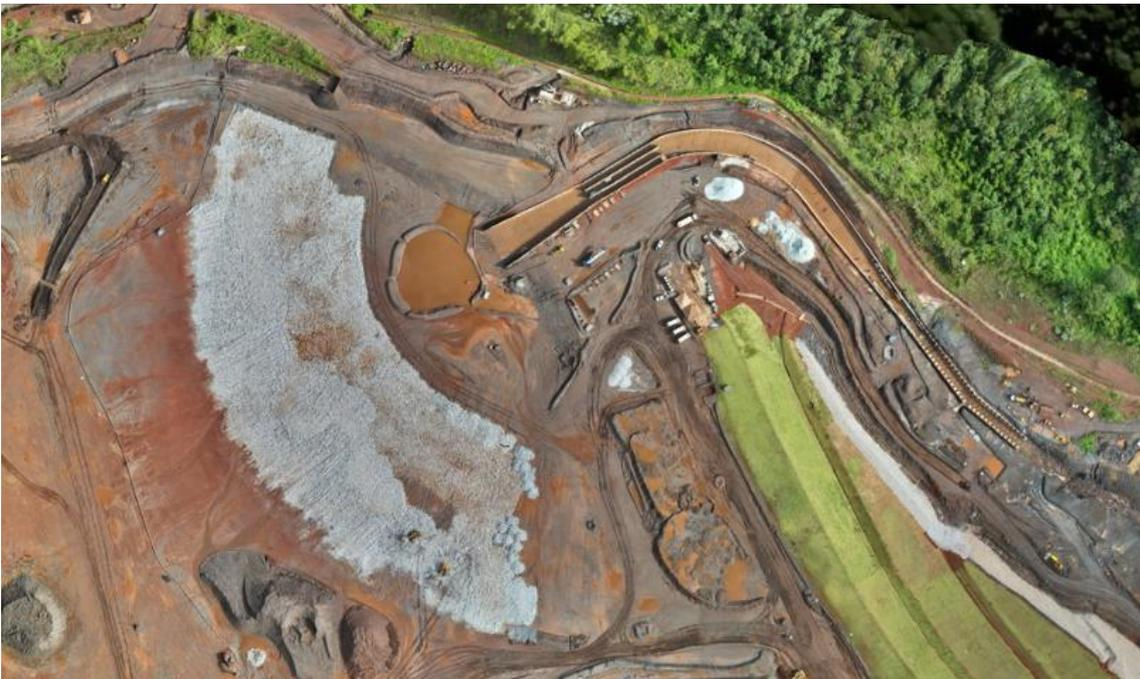
**Figura 50 - Emboque do canal de drenagem operacional (janeiro/25)**
