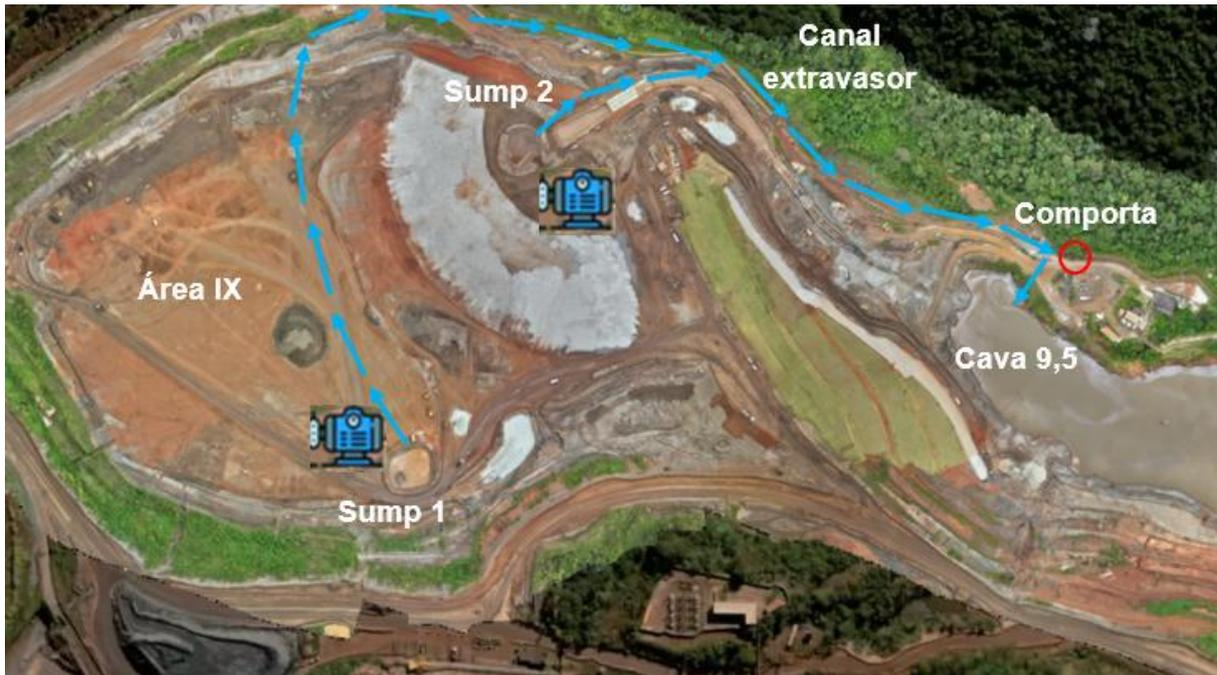
Figura 132 - Esquema dos bombeamentos e fluxos realizados em Área IX. Vale, 2025.
