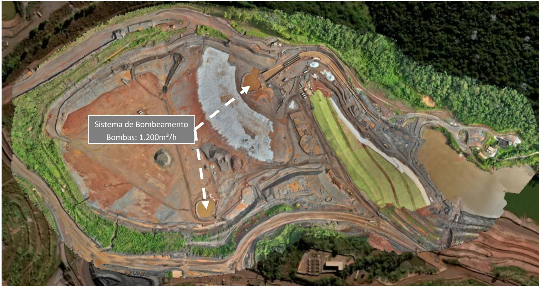
Figura 59 - Planta com o sistema de bombeamento operante no reservatório Área IX (status de janeiro/2025).
