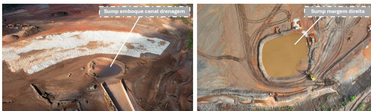
**Figura 32 - Sumps com bombeamento em operação (janeiro/25)**
