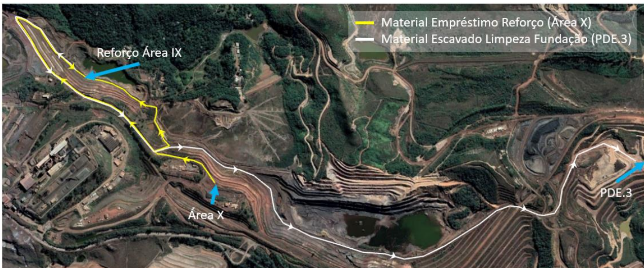
Figura 6. Movimentação de Terra - Etapa 1.
