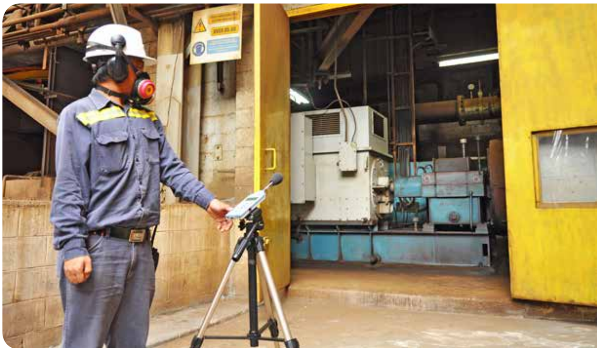
Uji kebisingan di area Pabrik Pengolahan Noise parameter testing at Process Plant
