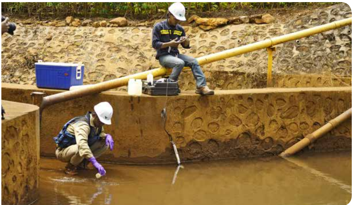
Pengukuran parameter padatan tersuspensi air tambang Measuring the mine water total suspended solids parameter
