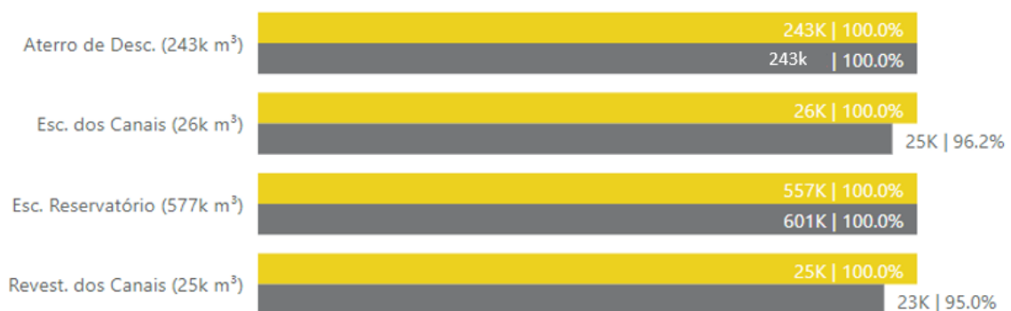
Figura 1 – Avanço da remoção de rejeitos na descaracterização, corte out/22. Fonte: Vale, 2022.
