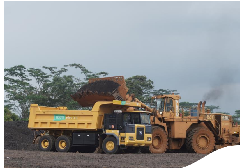
Alat berat jenis dozer mengangkut nickel slag ke truk elektrik yang dioperasikan oleh PT Vale Indonesia Tbk. Perusahaan produsen nikel ini menargetkan penurunan emisi karbon hingga 33% pada 2030 dan zero net carbon emission pada 2050.
