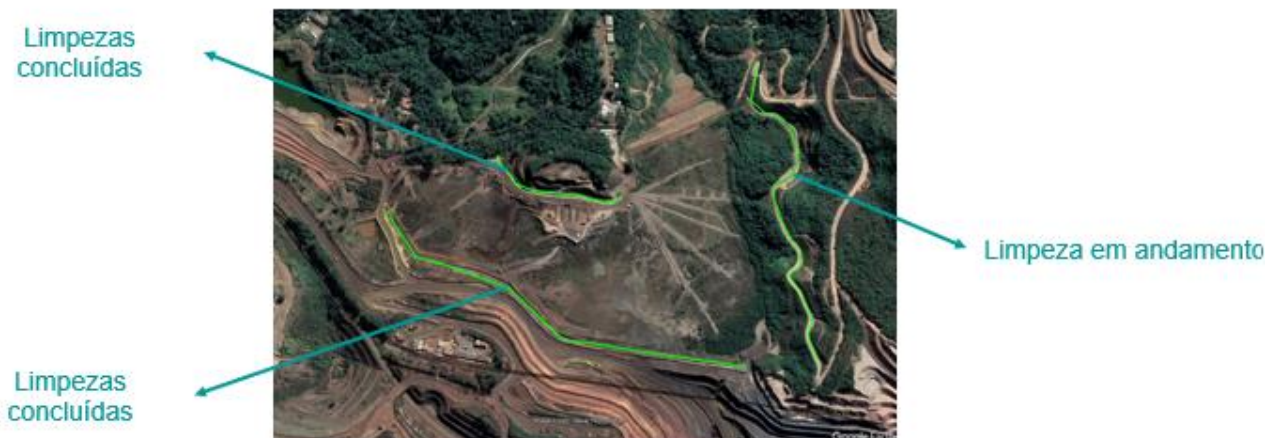
Figura 8: Status da limpeza e desobstrução dos canais de cintura – Grupo.
