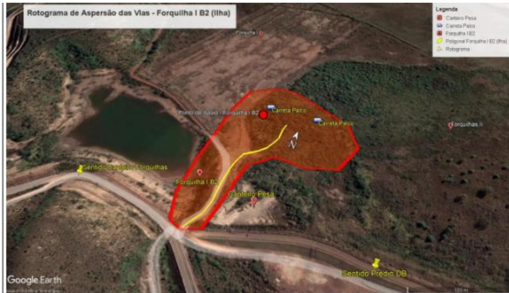
**Figura 23:** Rotograma para as obras complementares à descaracterização da barragem de Forquilha I, de responsabilidade da empresa Aterpa. Fonte: Vale, 2023.
